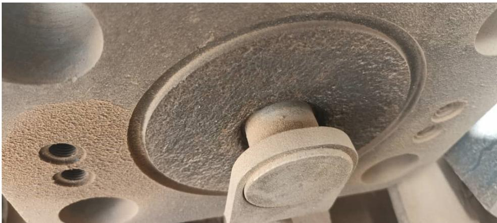
FIG. 4.9 : Perforation de l'intermediate flange
