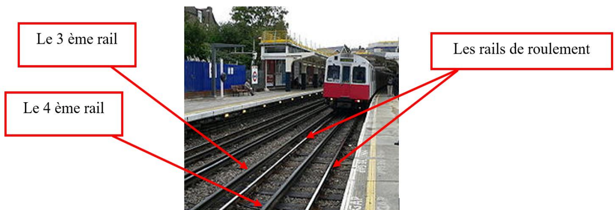
FIGURE 1.11- Alimentation par 3 ème et 4 ème rail [9]
