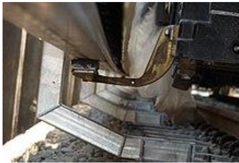
FIGURE 1.6- Contact des frotteurs avec le 3 ème rail [12]
