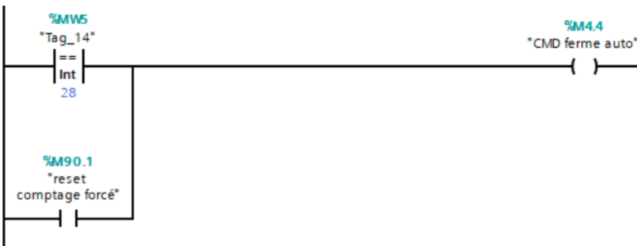
FIGURE 4.35 – Commande de fermeture automatique
