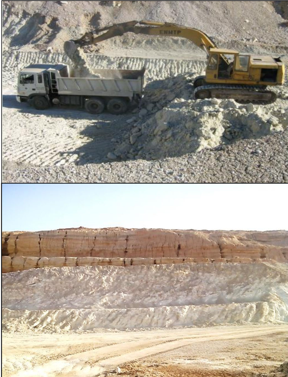
Figure 25 : Extraction bentonite et transport de tout-venant (carrière Roussel I).
