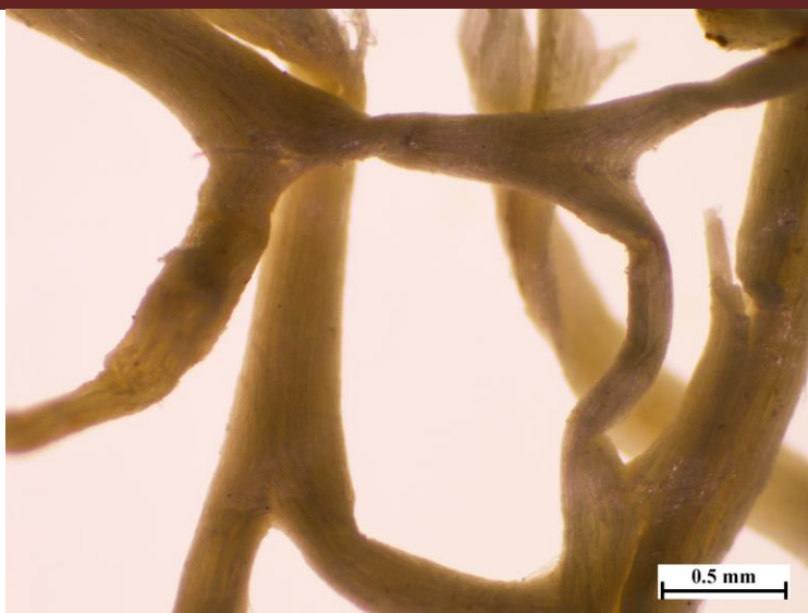
Figure 35 Morphologie du Luffa traitée au NaOH avec un objectif X50
