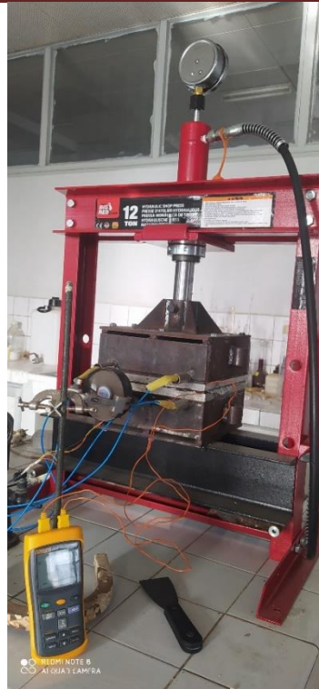
Figure 21 Etapes de la fabrication des plaques de composites : thermocompression
