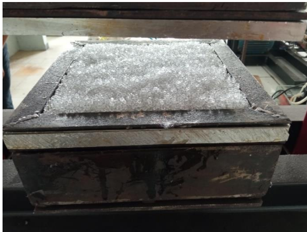
Figure 20 Etapes de la fabrication des plaques de composites : Fabrication de la plaque vierge
