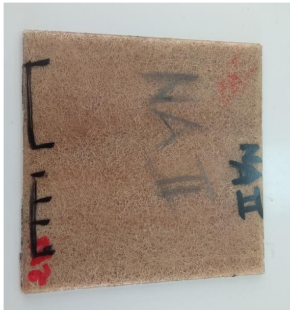
Figure 24 Plaque de fibre traitée au NaOH de 2 plis obtenue par thermocompression
