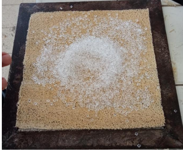
Figure 19 Etapes de la fabrication des plaques de composites : le garnissage en PS
