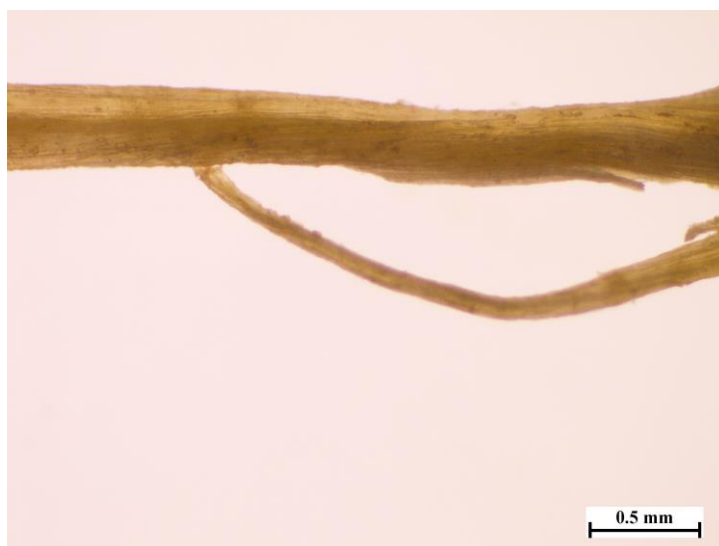
Figure 36 Morphologie du Luffa traitée au NaOH avec un objectif x 0.9
