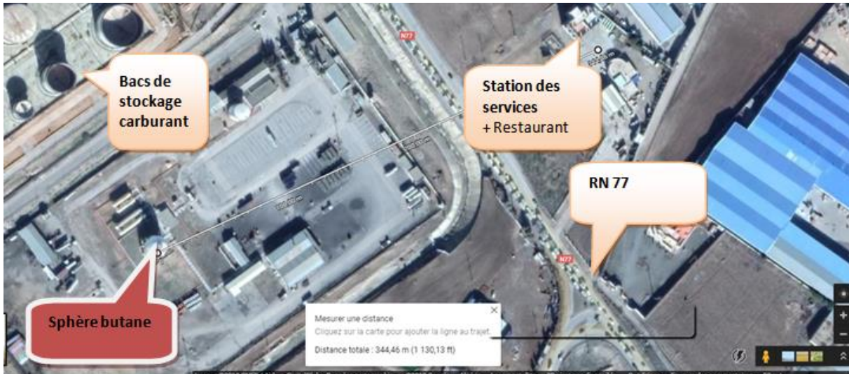
Figure 30 : positionnement des déférents cibles par à port au centre d'explosé
