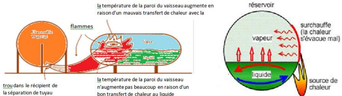
Figure 18 : Le mécanisme de formation du BLEVE chaud dû à un feu externe (Référence : Daniel A. Crowl "Understanding explosions", CCPS Publication, 2003)
