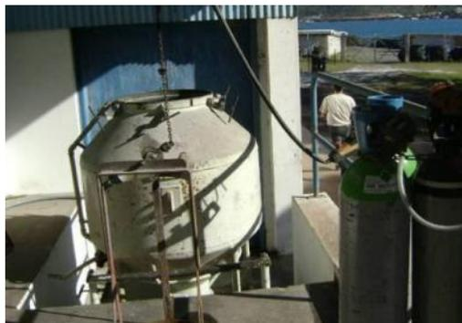
Figure 3-4 : Benne de chargement de carbure de calcium
