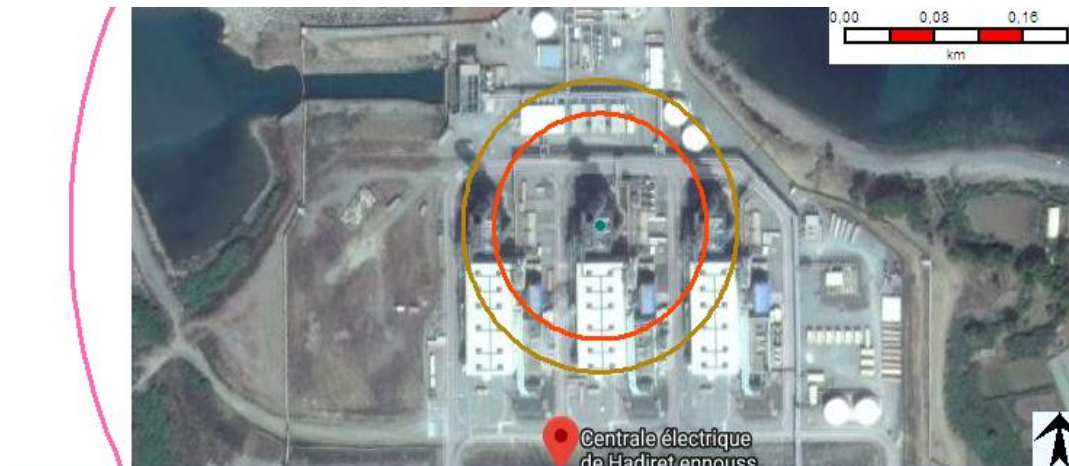
Figure IV-6 : Cartographie des Effets de la Surpression du TNT
