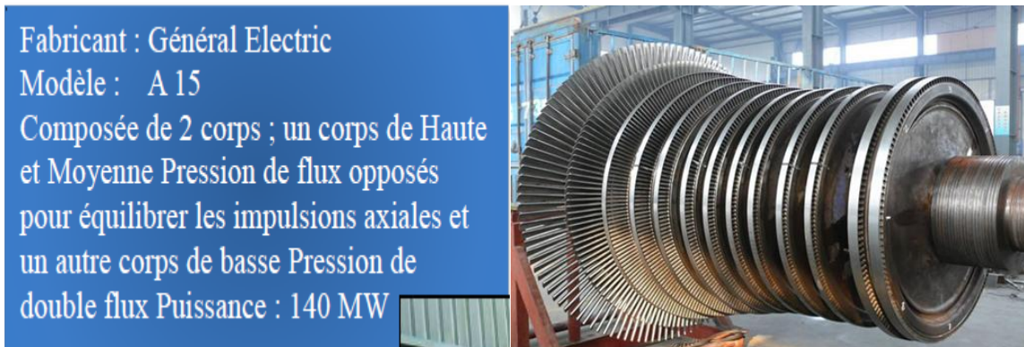
Figure II-4 : Caractéristique de la Turbine à Gaz Figure II-5 : Photo d'une Turbine à Gaz
