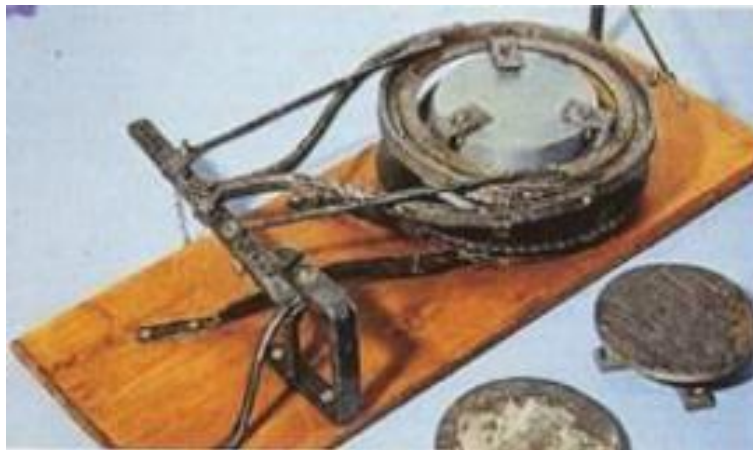
Figure 2-3: La machine à polir de William Herschel (Source : Lord Rosse, 1841)
