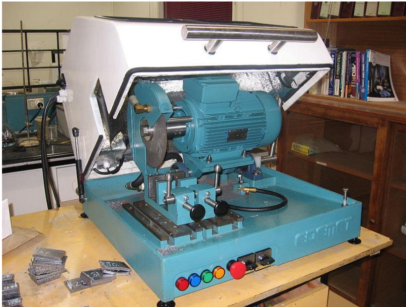
Figure 1-1: Tronçonneuse à eau pour prélever les échantillons sur de grosse pièces (département de génie métallurgique de la faculté d'ingénierie de l'université de Concepción, Chili)
