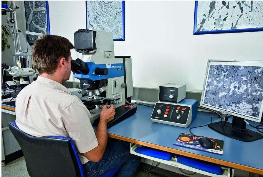
Figure 1-3: Microscope métallographique avec caméra numérique reliée à un PC ( https://commons.wikimedia.org/wiki/File:Materialanalyse_Mikroskop.jpg )
