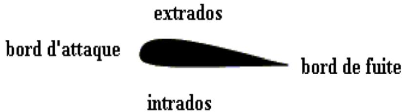
FIG. 2.3 : Caractéristiques géométriques d'un profil [21]
