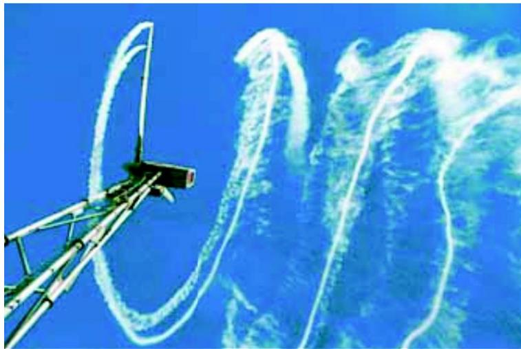
FIG. 2.10 : Rotation du sillage d'éoliennes.
