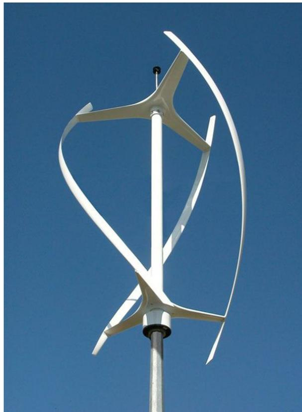
FIG. 1.8 : éolienne à axe vertical (éolienne de type Darrieus) [11]
