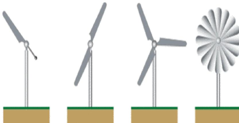
FIG. 1.10 : Distinction entre éoliennes à axe horizontal selon le nombre de pales [10]
