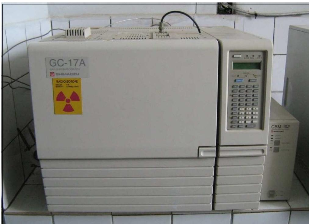
**Figure n°22 :** Le chromatographe CPG utilisé pour l'analyse des échantillons.
