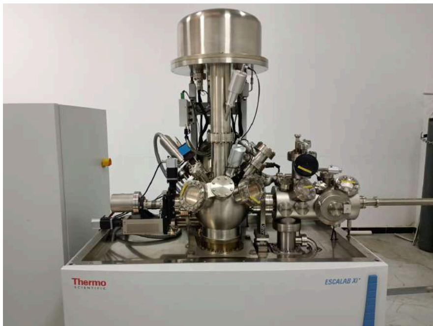
FIG. 3.12 : XPS Escalab Xi+ utilisé au CRTSE.
