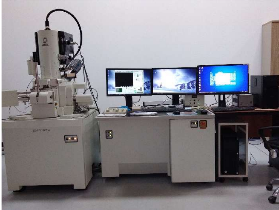
FIG. 3.10 : Microscope Electronique à Balayage (MEB) de type JSM-7610F Plus (CRTSE).
