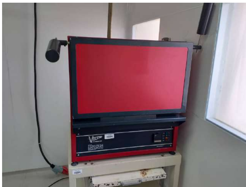
FIG. 3.6 : Four Vecstar furnaces utilisé pour le recuit sous atmosphère d'azote.
