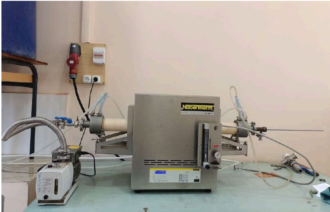
FIG. 3.5 : Four NABERTHERM utilisé pour le recuit sous vide.
