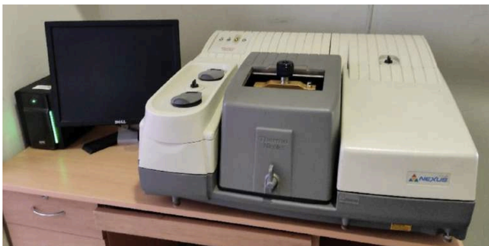
FIG. 3.13 : Spectroscopie infrarouge à transformée de Fourier, FTIR/ATR FTIR Thermo Nicolet NEXUS 670 [33].
