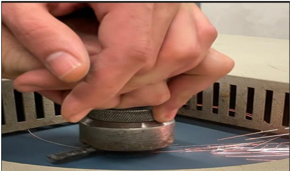
Figure IV.5: Opération de polissage.
