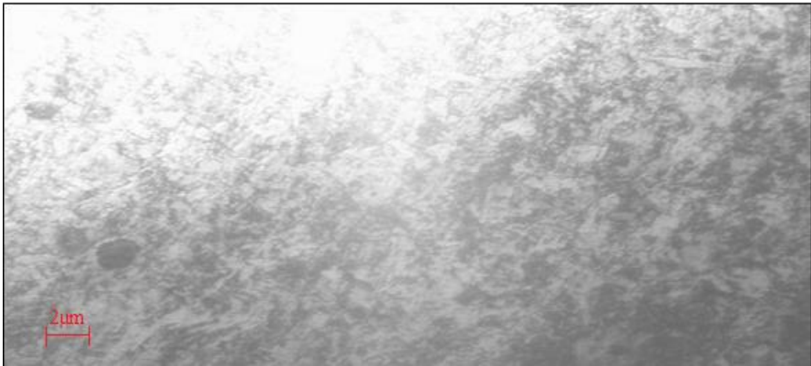
Figure V.5: Micrographie de la couche intermédiaire (bainite X500).
