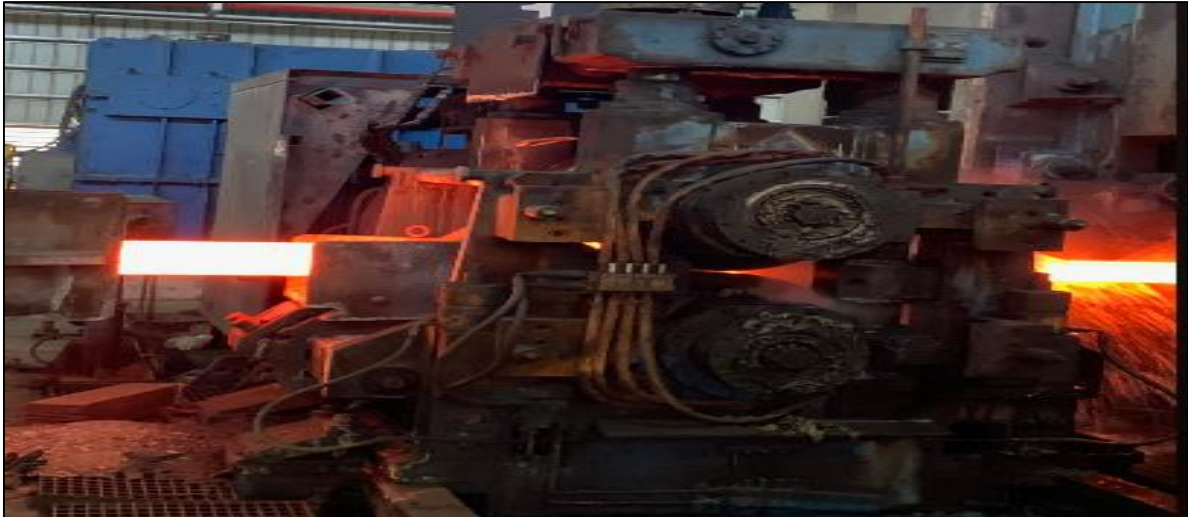
Figure II.12: Cage1 du dégrossisseur. [4]
