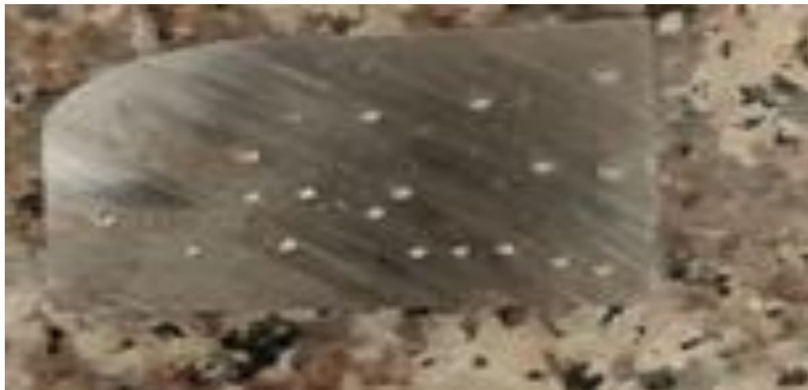
Figure IV. 15: Mesure de la dureté du produit sans traitement thermique.
