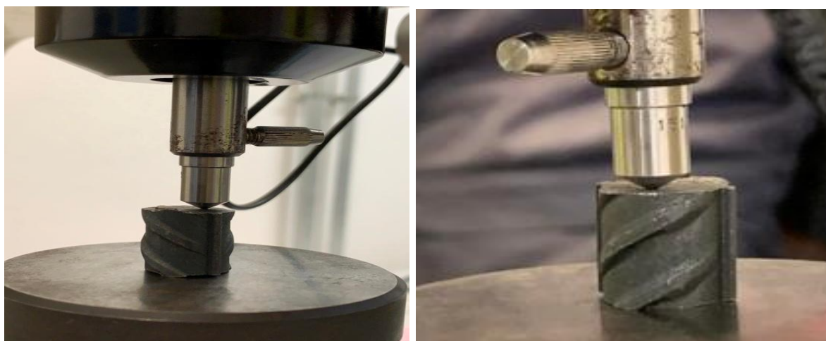
Figure IV.16: Mesure de la dureté du rond à béton diamètre 16 mm
