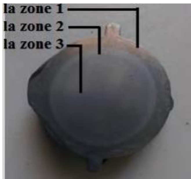
Figure V.1: Les trois zones : a- Zone trempée, b- Zone intermédiaire, c- Cœur.
