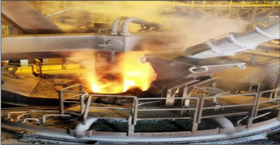
Figure II.6: Alimentation de pré réduit DRI.
