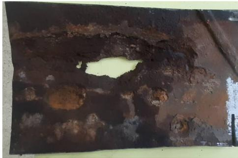
FIG. 3.8 : Echantillon de corrosion sous-dépôt prélevé de l'OH1
