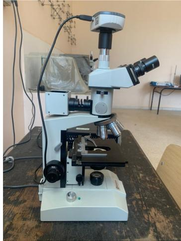
FIG. 4.6 : Microscope Optique
