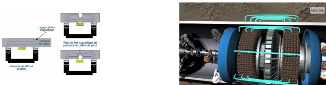
FIG. 4.17 : Principe de fonctionnement du MFL
