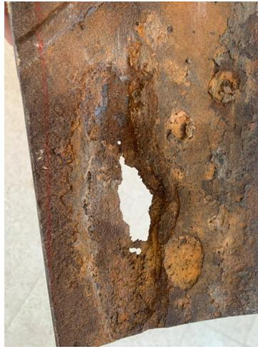
FIG. 4.1 : Photo de l'échantillon de corrosion prélevé de l'OH1
