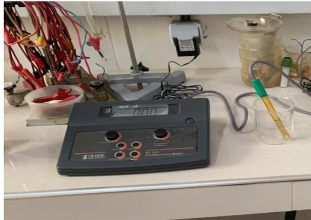
FIG. 4.10 : Mesure de la conductivité
