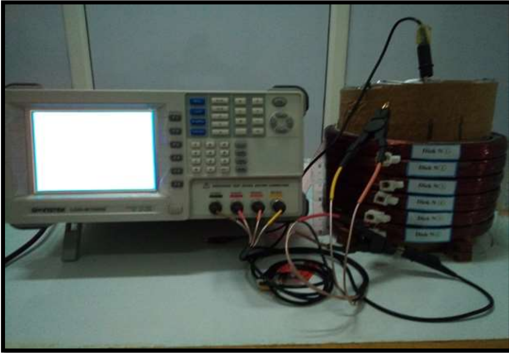
Figure 3.4. Représentation du test FRA expérimentale de l'enroulements réels au laboratoire de l'université DR. YAHIA Fares de Médéa
