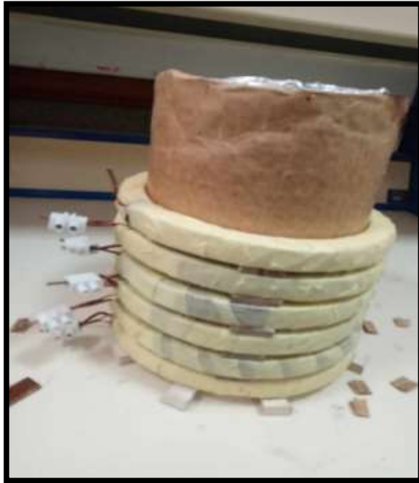
Figure 4.6. Déplacement axial entre D4 et D5 avec un déplacement plus ou moins important.
