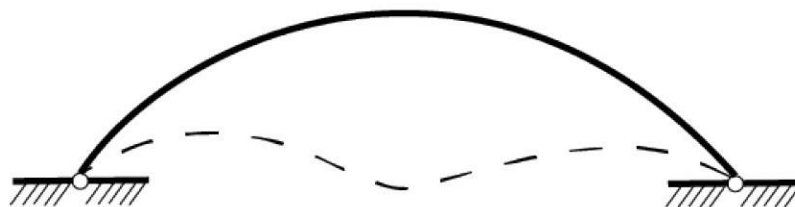
Figure 4.13. Affaissement de l'arc dans son plan « Snap-Through ».
