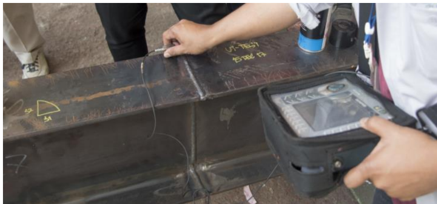
Figure 1.5. Contrôle de soudure par ultrason.
