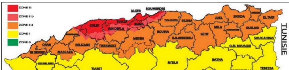
Figure 1-6 : Carte de zonage sismique du Nord d'Algérie [1]
