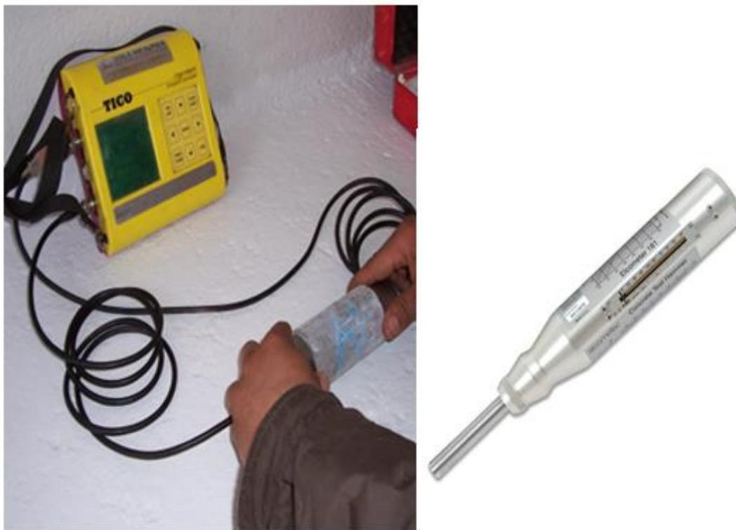
**Figure II-10 : Scléromètre à béton et appareil ultrasonique.**
