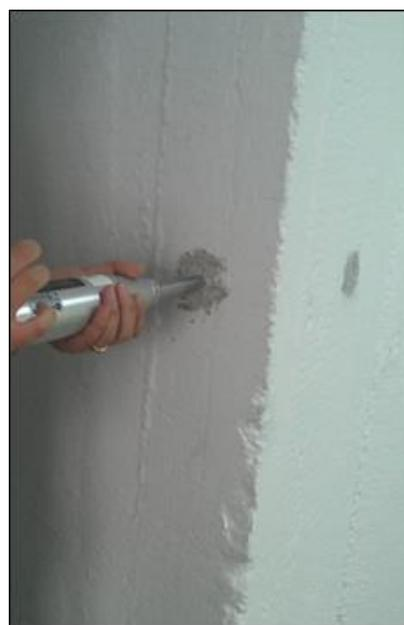
**Figure II-11 : Auscultation avec ultrason. Figure II-12 : Auscultation avec scléromètre.**
