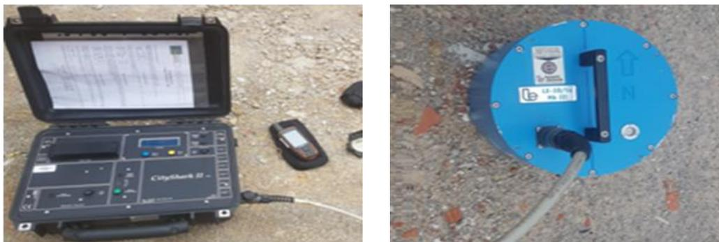
*Figure 2.11 - Matériel d'acquisition des mesures de bruit de fond structure : sismomètre Lennartz 5 secondes tri-composant (À droite), la station City Shark II™ (à gauche).*
