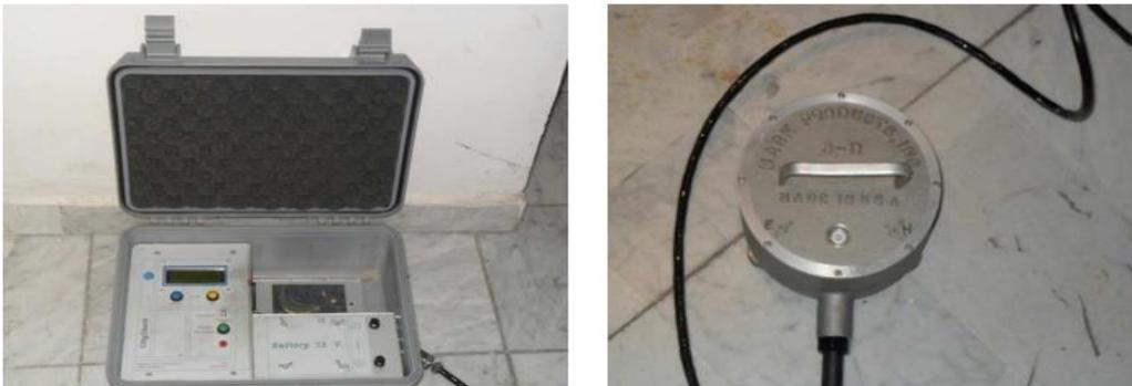
*Figure 2.10 - Matériel d'acquisition des mesures de bruit de fond structure : le capteur vélocimètre 2s (À droite), la station City Shark II (À gauche).*
