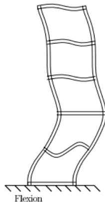
*Figure 2.5 - Comportement en flexion d'une structure. (Dunand 2005)*
