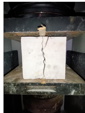
FIGURE 5.15 – Essai fendage des éprouvettes
