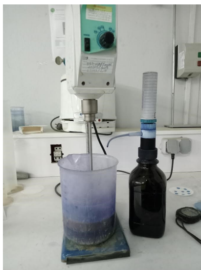
FIGURE 5.4 – Essai de Blue de méthylène
