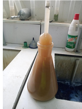
FIGURE 5.6 – Sable 0/1 dans le pycnomètre
