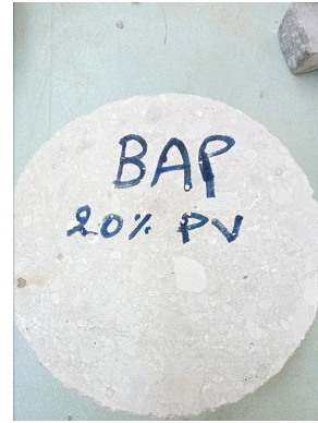
FIGURE 5.13 – Epreuve de béton après surfacage
