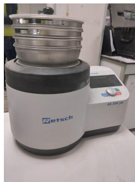
FIGURE 5.8 – Appareillage de l'essai reufs à 45 \mu\text{m}
