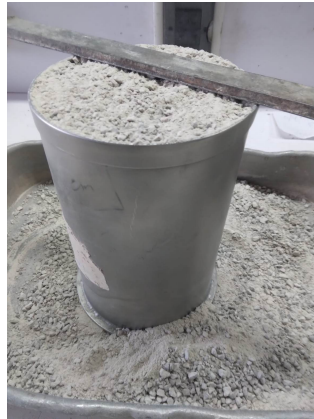
FIGURE 5.10 – Un mélange composé de 90% de sable 0/4 et de 10% de sable 0/1 dans un réceptent
