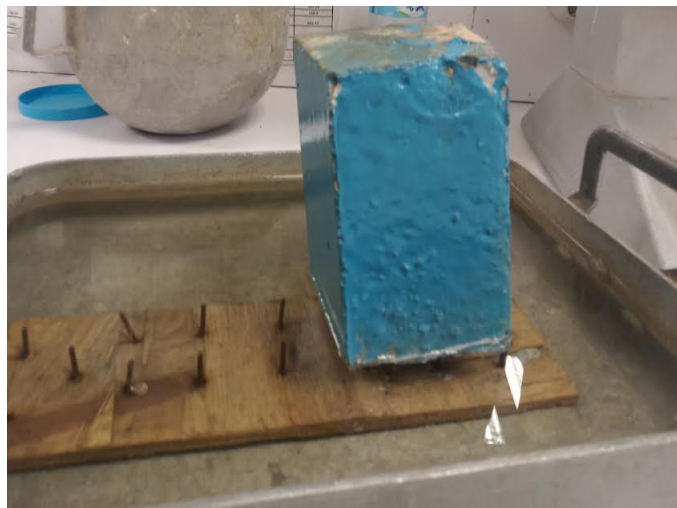
FIGURE 5.18 – Éprouvette résinée immergé dans l'eau
