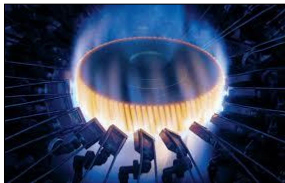
Figure 1-14 - Trempe au chalumeau
