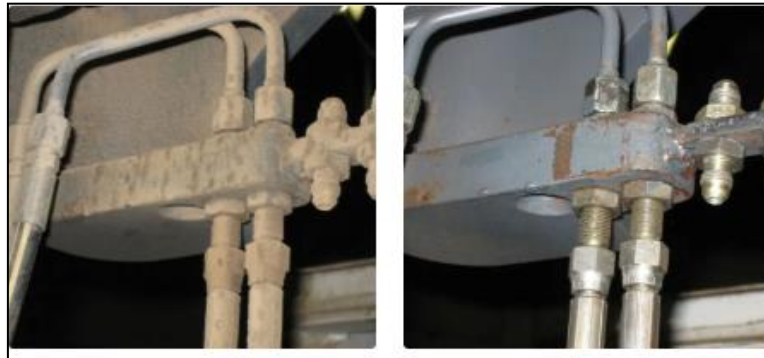
Figure 1-9 - Résultat d'un nettoyage par cryogénie
