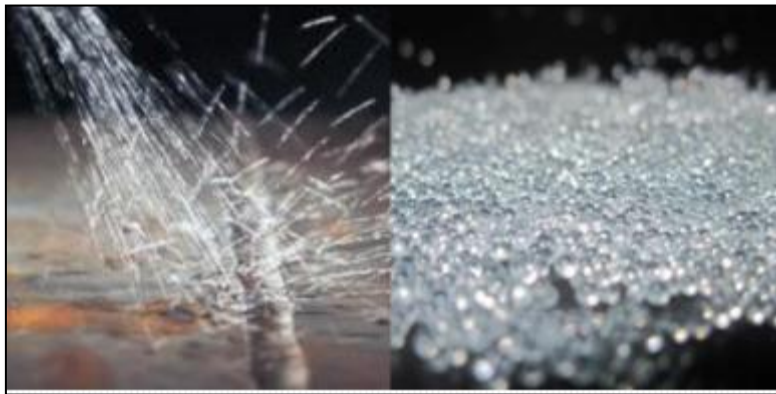
Figure 1-5 - Traitement de surface par microbillage [1]
