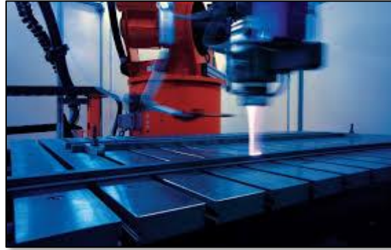
Figure 1-16 - Trempe au laser
