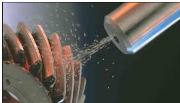
Figure 1-3 – Traitement de surface par grenailage [2]
