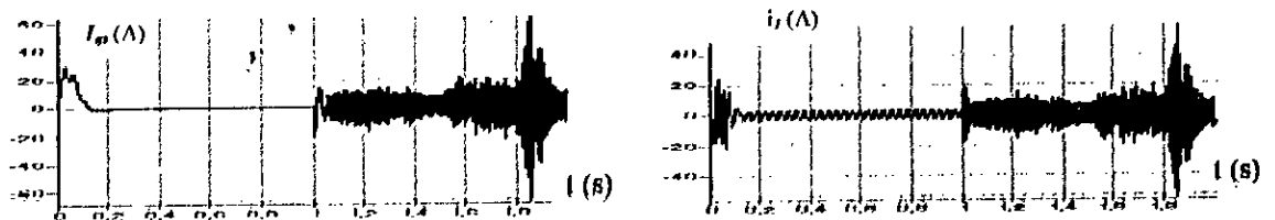
Fig.V.15- Courant quadratique i_{q3} et le courant d'une phase de la machine asynchrone i_1
