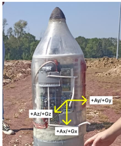
Figure 7. 25 : Orientation des axes de la centrale inertielle.
