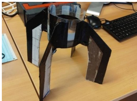
Figure 7.10 : Fixation des ailettes plates sur le jupon de la fusée à eau.
