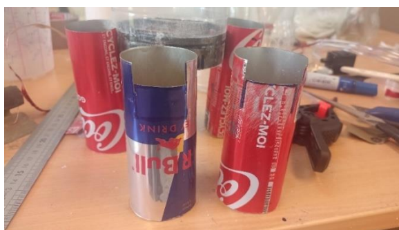
Figure 7. 12 : Réalisation des ailerons tubulaires en canettes de Soda.
