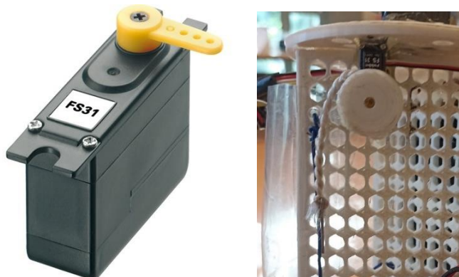
Figure 6. 26 : Servomoteur monté sur la structure
