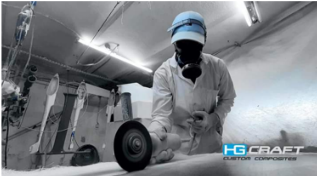
FIGURE 3.46 – Précision sur Mesure : Découpe de la Plaque Composite pour la Forme de la Pale d'Éolienne
