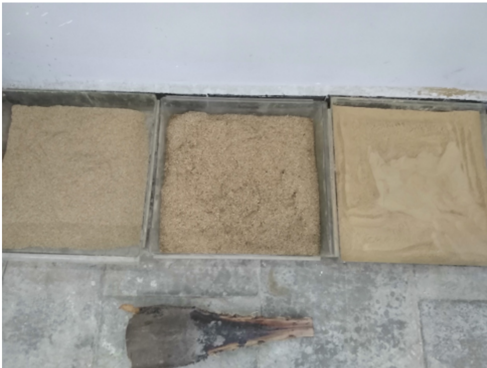
FIGURE 2.11 – Particules de bases pétiolées (kornaf) de palmier dattier après tamisage
