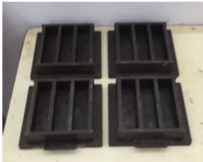
FIGURE 4.16 – Le moule métallique pour les tests de compression
