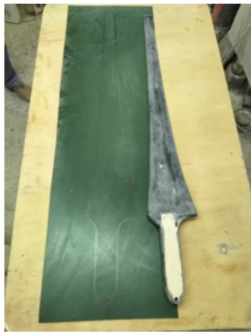
FIGURE 3.47 – La Préparation Précise : Avant la Découpe de la Plaque Composite pour la Forme de la Pale d'Éolienne
