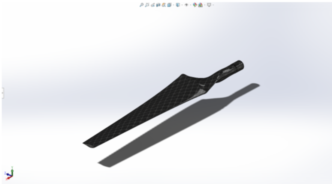
FIGURE 3.3 – Pale d'éolienne de profil S809 par similitude 'SolidWorks'
