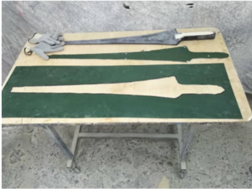
FIGURE 3.48 – Une Forme Parfaite : Après la Découpe de la Plaque Composite pour la Forme de la Pale d'Éolienne
