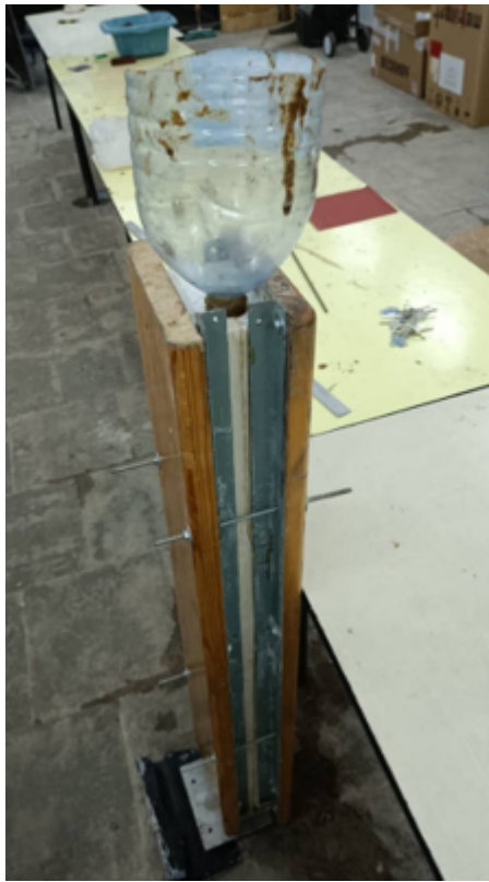
FIGURE 5.10 – Le moule avant l'injection de la solution préparée.
