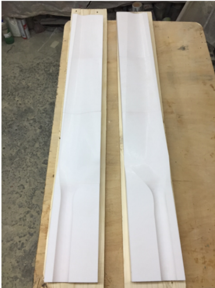
FIGURE 3.22 – Moule des pales d'éolienne
