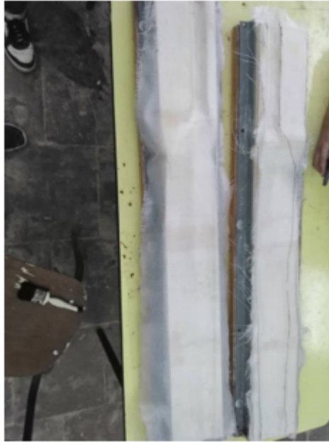
FIGURE 5.14 – Application précise du tissu de roving sur les parties extrados et intrados
