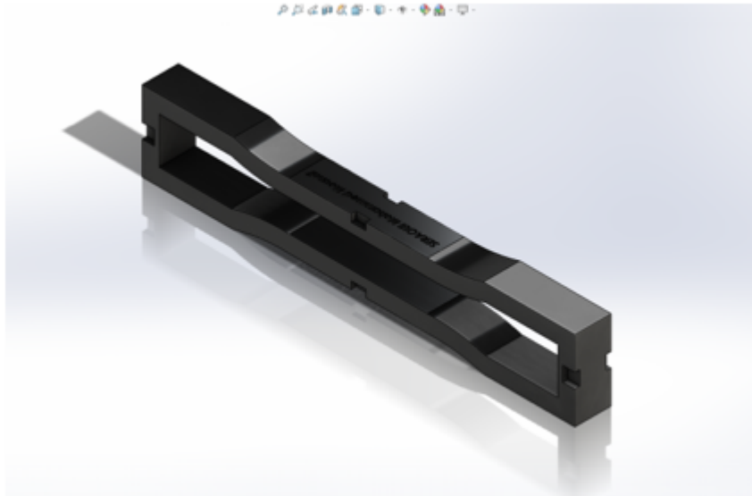
FIGURE 3.36 – Conception du moule des éprouvettes première partie 'Pièce 01'
