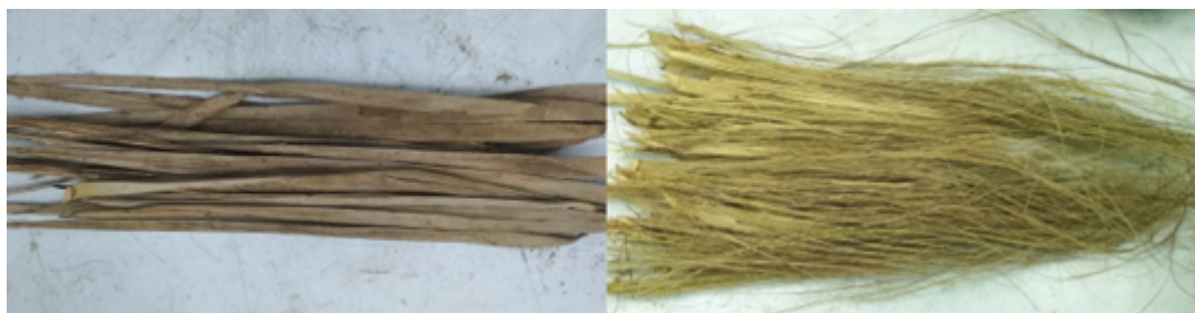
FIGURE 2.5 – Fibres de palmier dattier avant et après l'extraction manuelle
