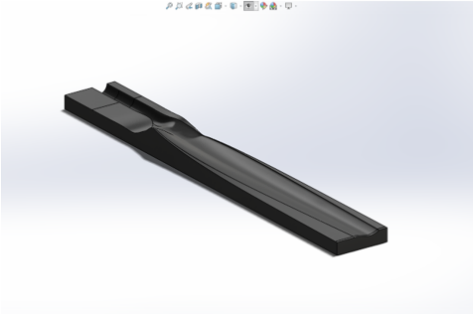
FIGURE 3.8 – Plan de coupe : Conception stratégique de la partie inférieure du moule pour la pale d'éolienne
