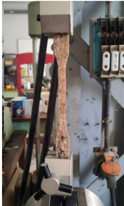
FIGURE 4.21 – Positionnement de l’éprouvette de traction dans la machine d’essai
