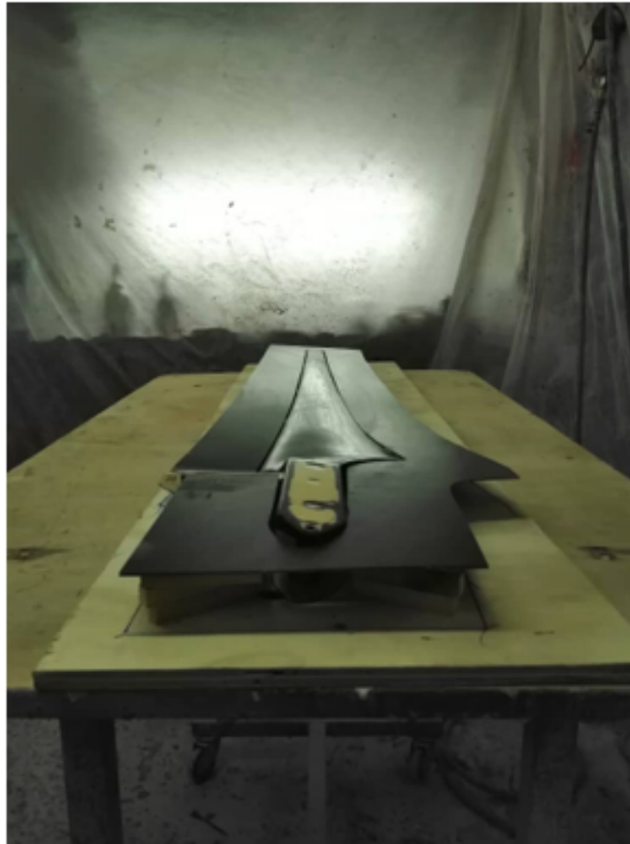
FIGURE 3.49 – Alignement Précis de la Plaque Coupée : Résultat de l'Équilibrage pour la Forme de la Pale d'Éolienne
