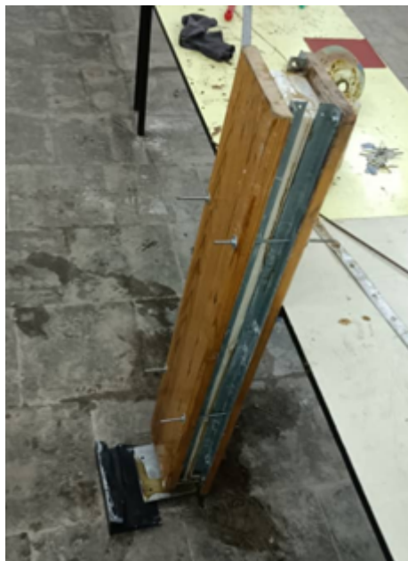
FIGURE 5.11 – Le moule après l'injection du mélange préparé
