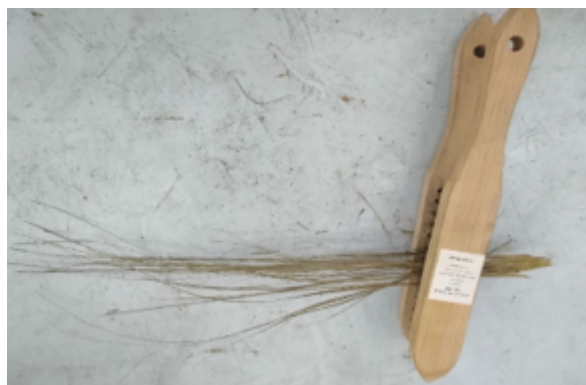
FIGURE 2.6 – Processus d'extraction manuelle des fibres de palmier dattier à l'aide de brosses métalliques
