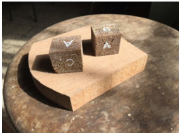
FIGURE 4.18 – Forme finale des éprouvettes de compression après moulage
