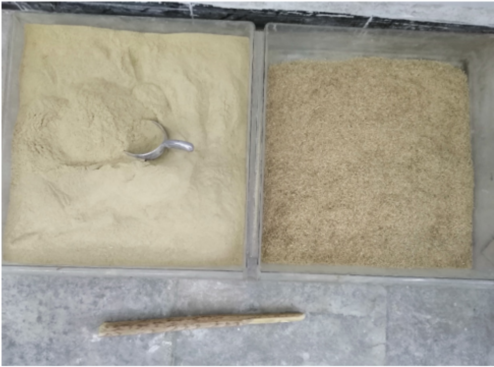
FIGURE 2.12 – Particules tiges de palmier dattier après tamisage
