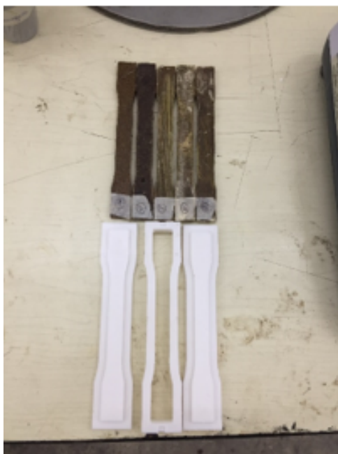
FIGURE 4.17 – Le moule des éprouvettes pour les tests de traction selon la norme ASTM D638
