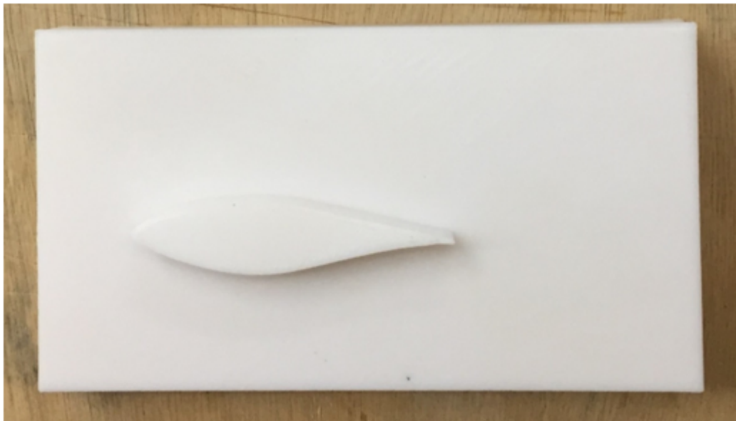
FIGURE 3.26 – Bouchon 02 pour l'extrémité du moule de la pale d'éolienne.
