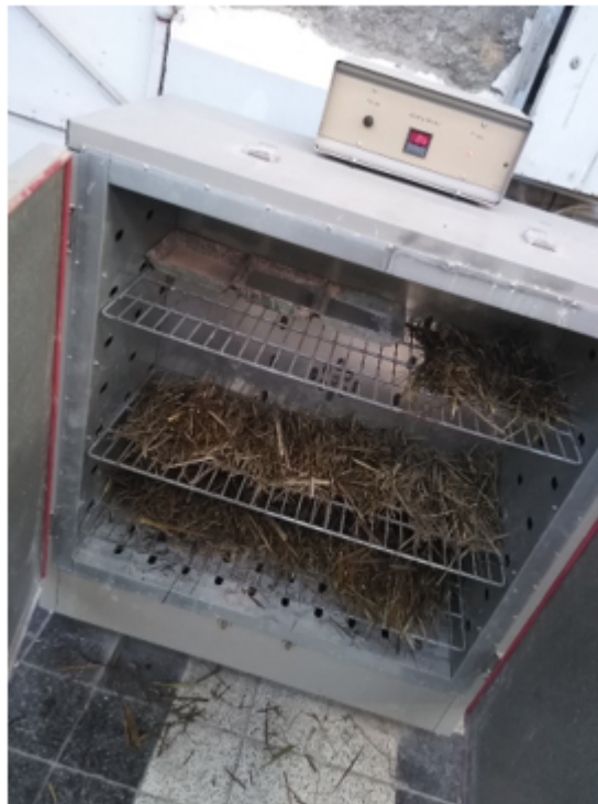
FIGURE 2.15 – Processus de séchage des fibres de palmier dattier
