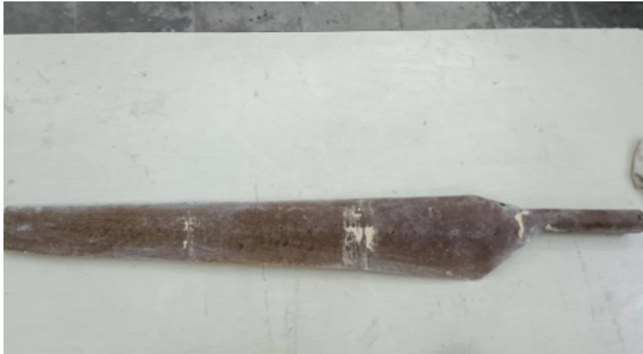
FIGURE 5.12 – Le démoulage de la pale : libérer la pièce finale.
