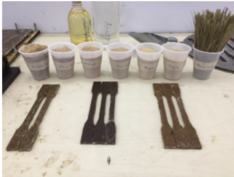
FIGURE 4.19 – Forme finale des éprouvettes de traction de compression après moulage
