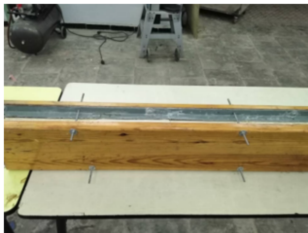
FIGURE 5.5 – Position verticale du système de fixation pour l'injection par gravité
