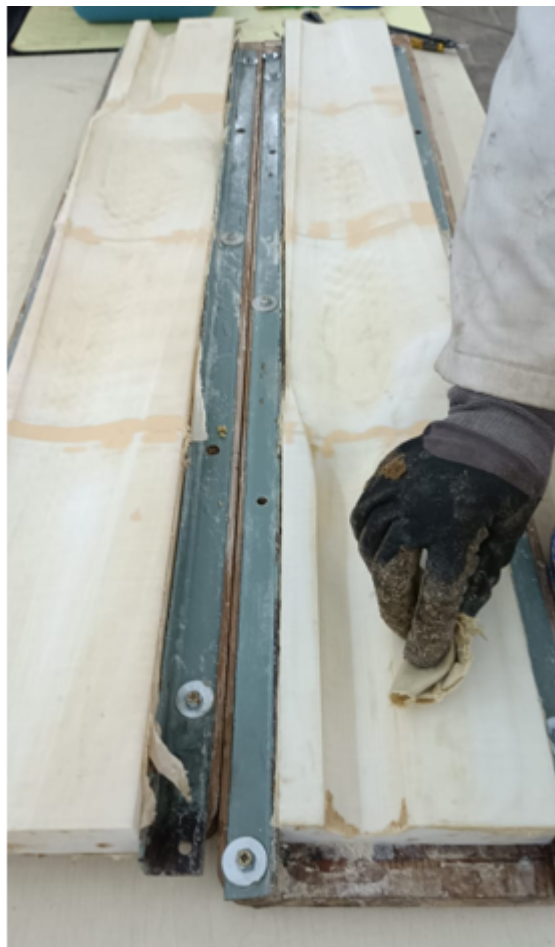
FIGURE 5.3 – Application de la pâte démoulant
