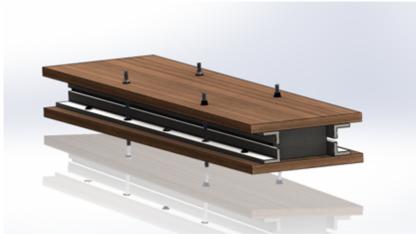
FIGURE 3.33 – Moule avec système de fixation réalisé au niveau du laboratoire
