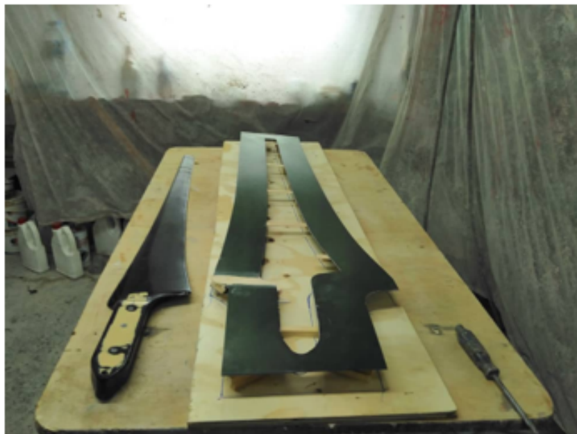
FIGURE 3.50 – Empreinte de la Pale d'éolienne et Cales pour l'Alignement Précis
