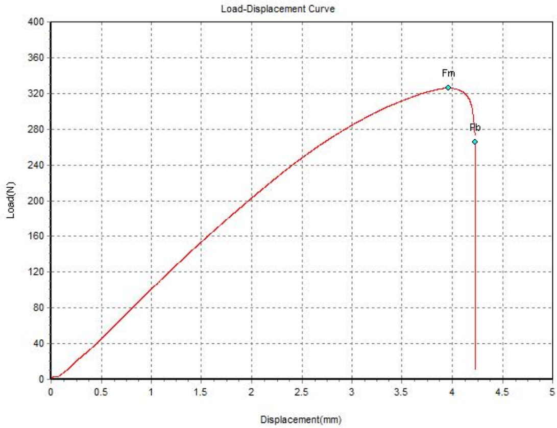
FIGURE 4.24 – Force déplacement des éprouvettes en fibres courtes des tiges (1)
