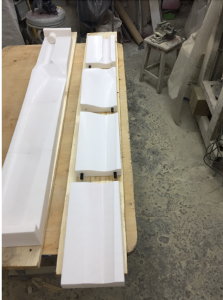
FIGURE 3.21 – Moule des pales d'éoliennes
