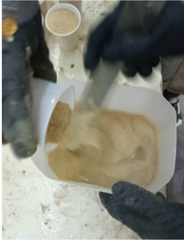
FIGURE 5.9 – Ajout des particules tiges : Intégration des particules tiges dans le mélange de résine époxy.
