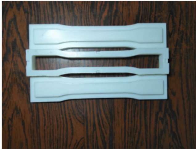
FIGURE 3.42 – Moule des éprouvettes conforme à la norme ASTM D-638.
