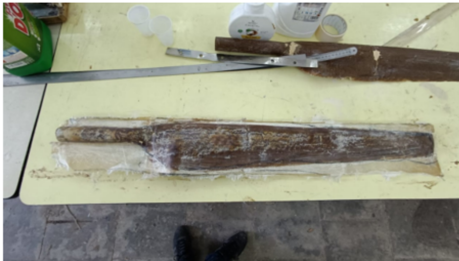
FIGURE 5.16 – Le démoulage de la pale : libérer la pièce finale
