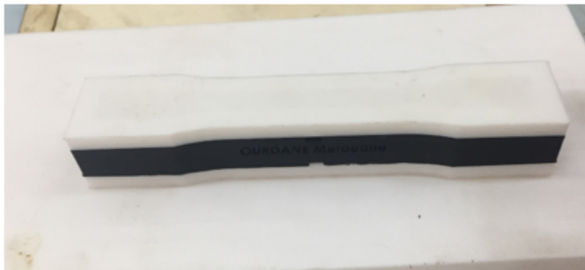
FIGURE 3.43 – Moule des éprouvettes assemblé conforme à la norme ASTM D-638
