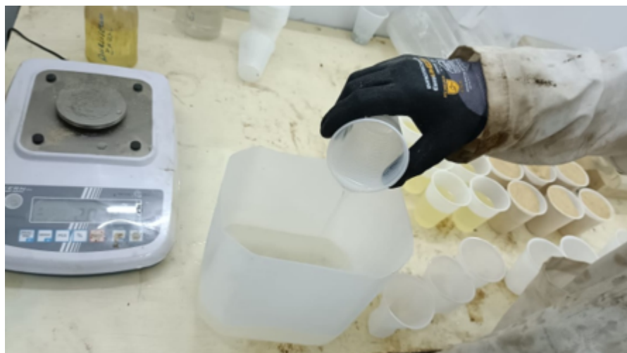
FIGURE 5.7 – Injection de la résine A : Remplissage initial avec la résine époxy A.
