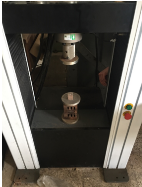
FIGURE 4.22 – Positionnement de l'éprouvette de compression dans la machine d'essai
