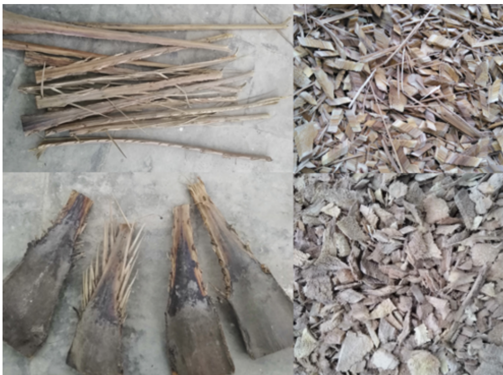
FIGURE 2.8 – Tiges et bases pétiolaires (kornaf) de palmier dattier avant et après le broyage avec le broyeur GHE 150 STIHL
