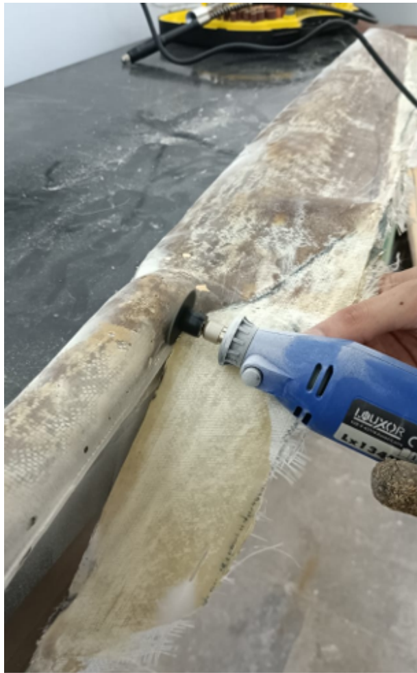
FIGURE 5.17 – Utilisation de la machine de sculpture et de polissage pour ajuster les pales hybrides
