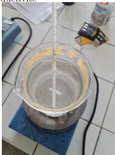
FIGURE 3.7 – Échantillon après apparition de sels
