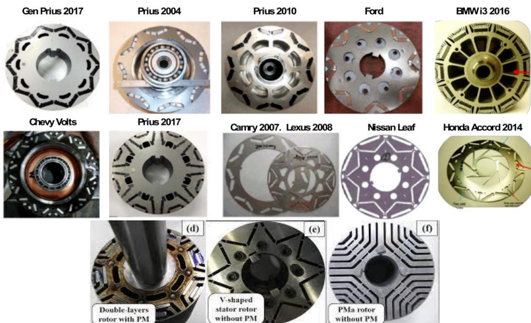
Figures 6 - Exemples d'applications des différentes configurations des rotors IPM existants [38]
