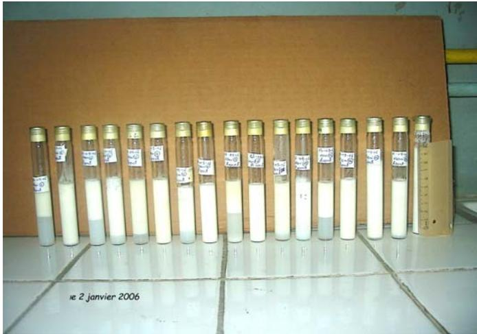
**Figure n° 22 :** Aspect des émulsions après 3 mois et demi de stockage à température ambiante
