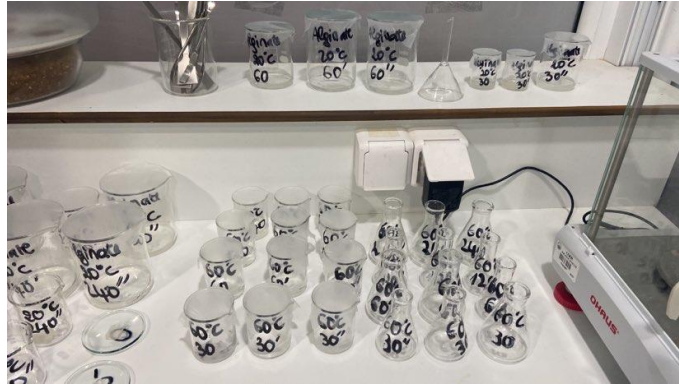
Figure 2-3 : Tests de prise d'eau des membranes PVA, et PVA-AS
