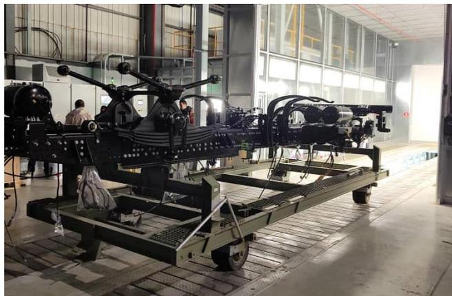
Figure 1-5: Châssis d'un camion de type ACTROS
