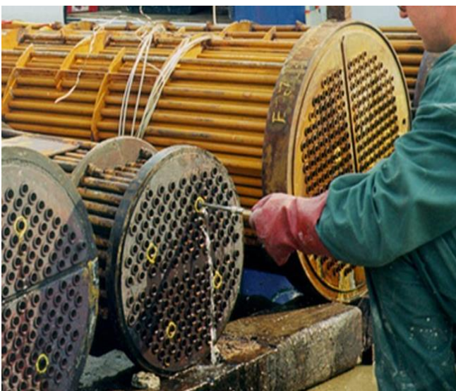
Figure III. 11 : Le système d'inspection rotative interne (IRIS)
