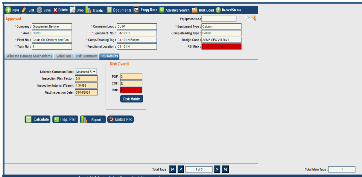
Figure 4.12: Fenêtre montre le résultat du RBI global pour une vitesse de corrosion à court terme
