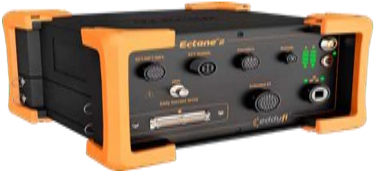
Figure III. 10 : Contrôle par courants de Foucault (ECT)
