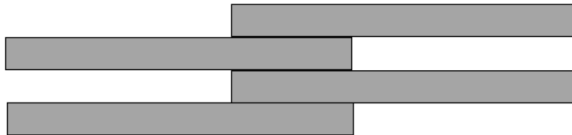
FIGURE 2.1 – Schéma plan d'un joint à double recouvrement
