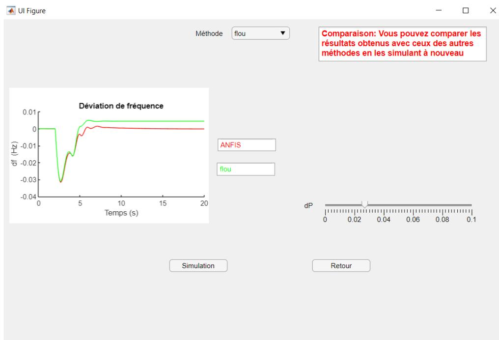
Figure 4.6 : Comparaison avec le régulateur flou pour le cas mono-zone
