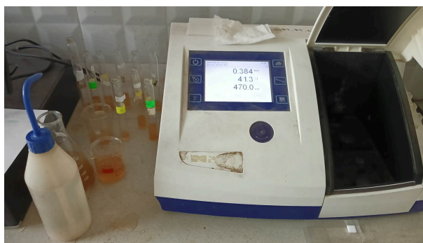
FIG. 3.13 : Analyse du phosphore par spectrométrie.
