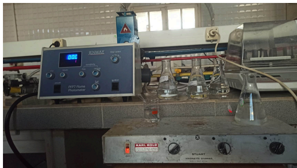
FIG. 3.12 : Réglage du blanc dans le photomètre à flamme.
