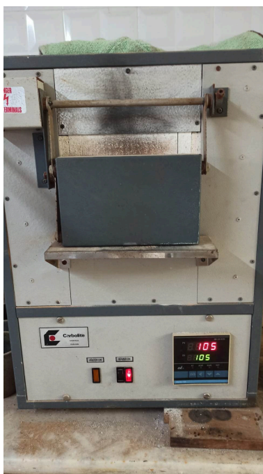
FIG. 3.2 : Échantillons dans le four pour déterminer la teneur en eau.
