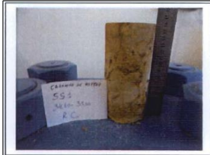
Figure IV.12 : photo d'échantillon de sondage SS-1 utilise pour l'essai de compression [34]
