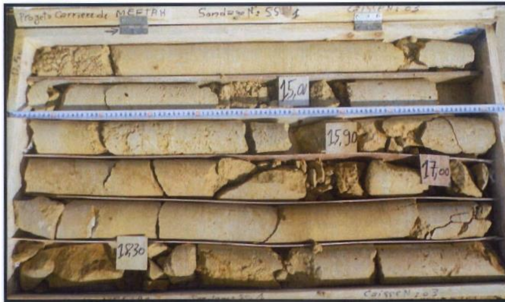
Figure IV.4 : caisse a carotte de sondage SS-1 [33]
