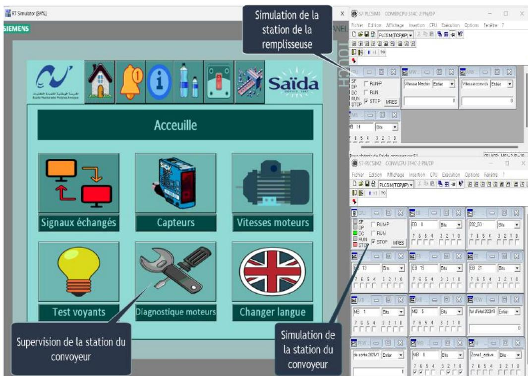
FIG. 5.7 : La simulation avec PLCSIM et le Runtime
