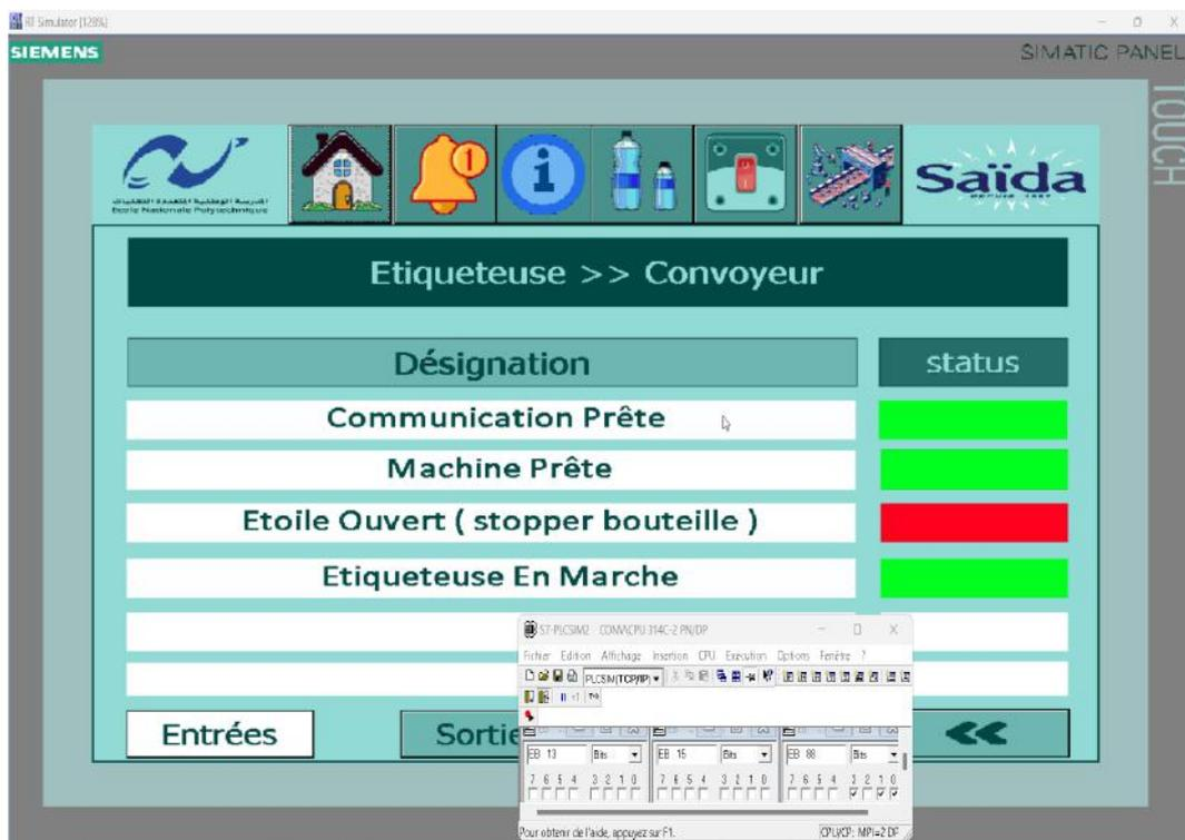
FIG. 56 : Vue signaux d'entrée ( étiqueteuse vers convoyeur )
