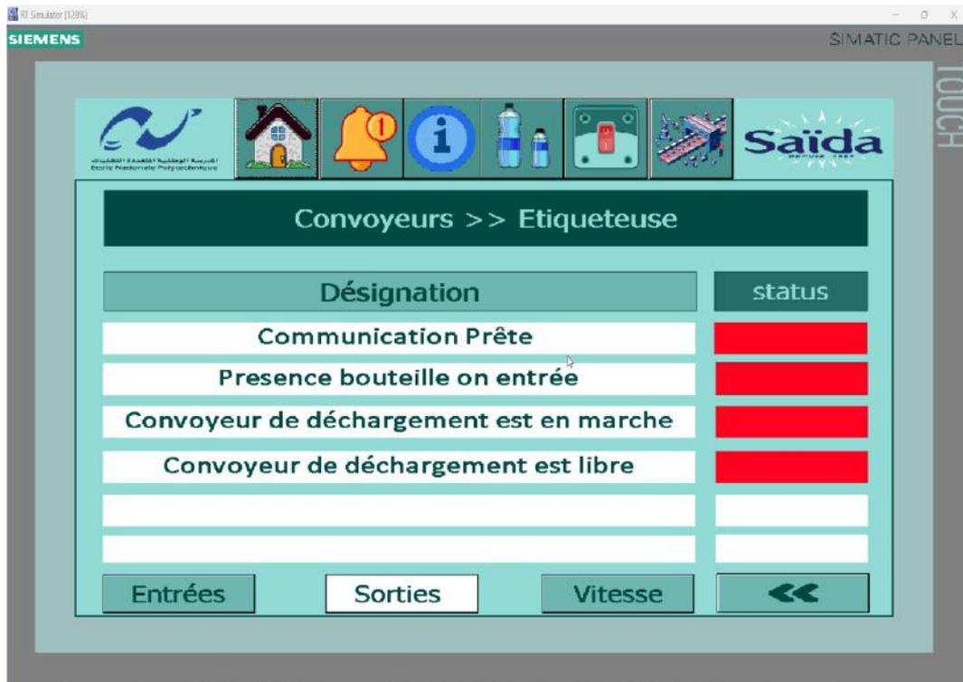
FIG. 55 : Vue de signaux de sortie ( convoyeur vers étiqueteuse )
