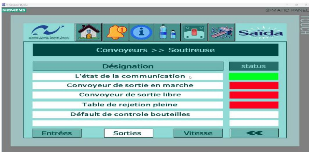
FIG. 52 : Vue de signaux de sortie ( convoyeur vers la soutireuse )
