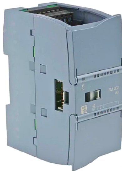
FIGURE 1.4 – Module de sorties analogiques SM 1232 (Réf : 6ES7232-4HD32-0XB0) [5]
