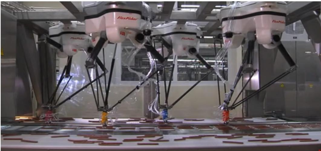
FIG. 1.13 : Robot Delta prise-dépose
