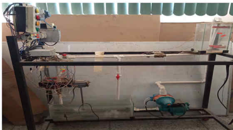
FIGURE 1.1 – Maquette de la station de pompage
