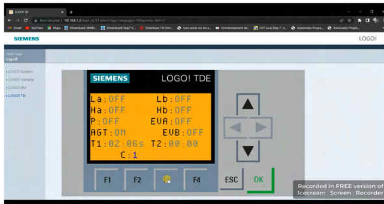
FIGURE 3.28 – Commande et la supervision avec LOGO! TDE sur Web Server
