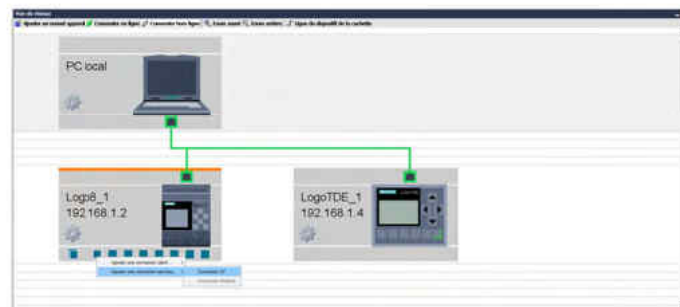
FIGURE 4.38 – Configuration réseaux du client/serveur
