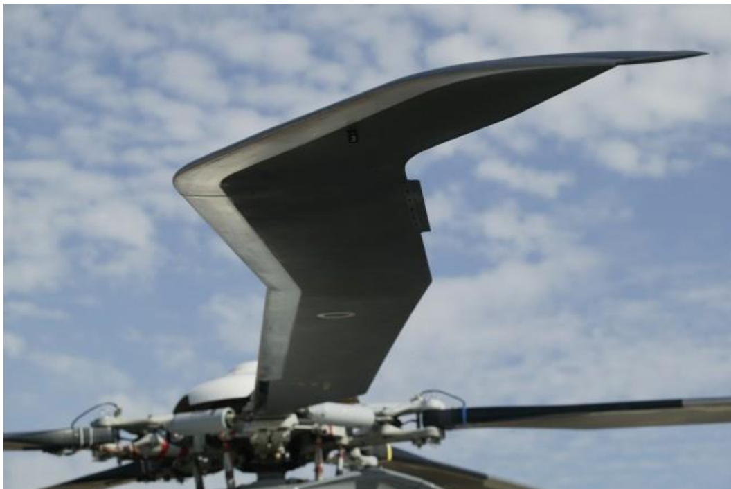
Figure 11 : Design de pale « Blue Edge »
