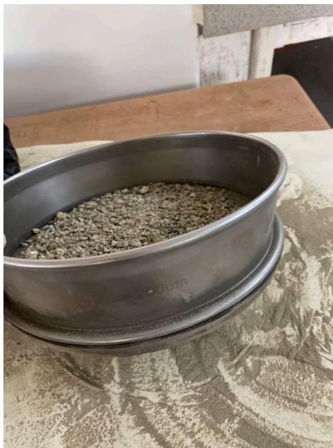
FIG. 2.16 : Tamisage des rejets KOT
