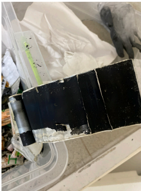
FIG. 2.6 : Poudre cathodique collée aux FPS
