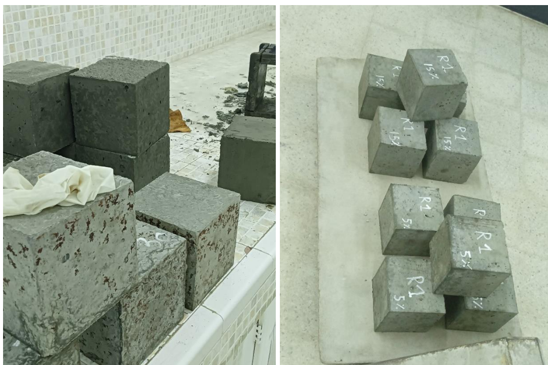
Figure 46 : Epreuve du béton lors de démoulage
