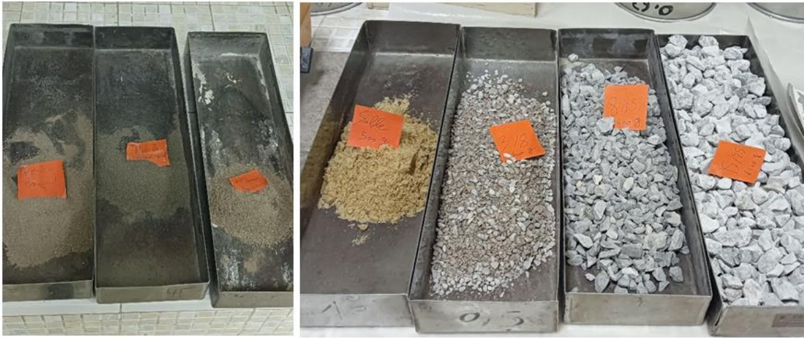
Figure 23: Prises des masses des granulats et rejets
