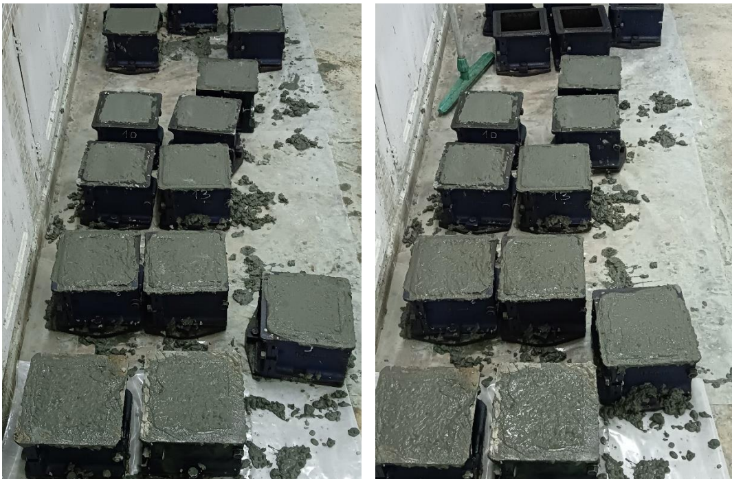
Figure 45 : Moules remplis du béton
