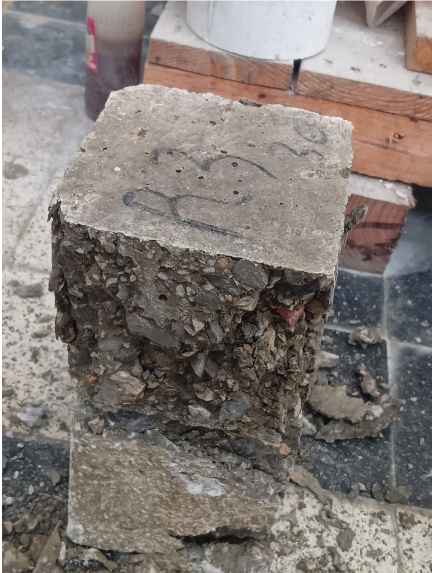
Figure 68 : exemple d'une rupture incorrecte pour l'éprouvette à base de rejet R3
