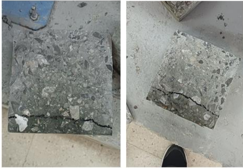
Figure 53 : Trace d'eau pénétrée au fond de l'éprouvette
