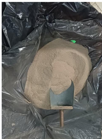
Figure 20: Rejet plomb-zinc Boucaid homogène (R2)
