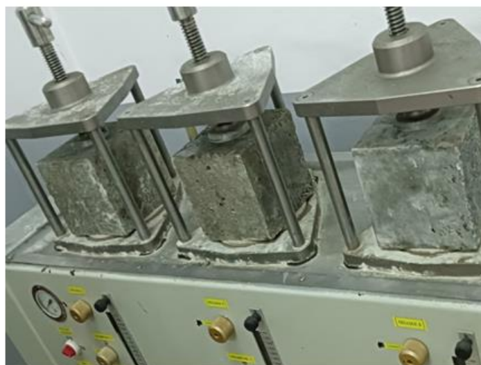
Figure 51 : Essais de pénétration d'eau
