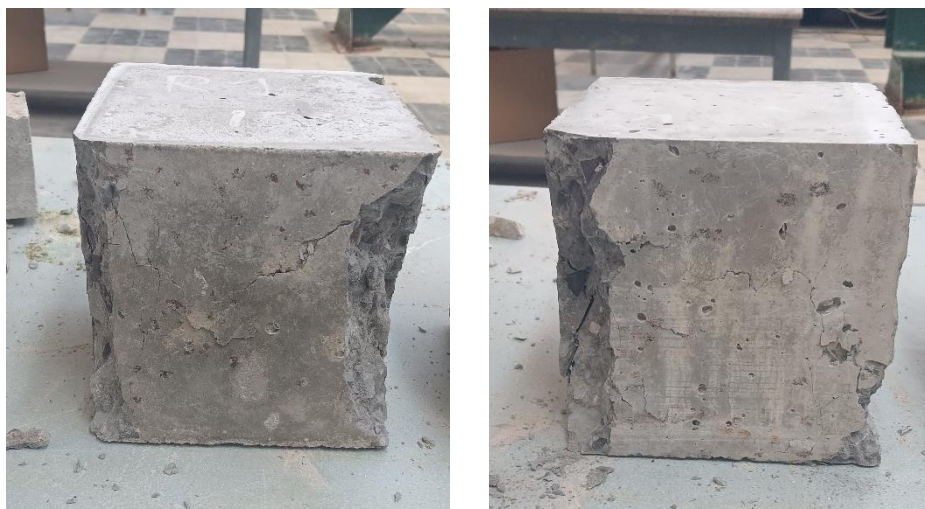
Figure 66: exemple d'une rupture correcte pour l'éprouvette à base de rejet R1
