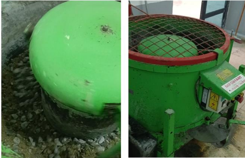
Figure 42 : Malaxage du béton dans un malaxeur
