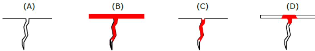
Figure 2.6. Principe du test de ressuage: (A) fissure de rupture, (B) application du pénétrant, (C) l'excès de pénétrant enlevé, (D) l'application du révélateur [12]
