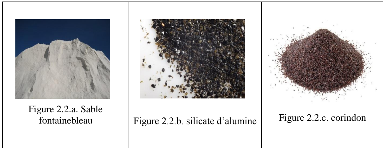
Figure 2.2 Différents abrasifs utilisés par sablage [8]
