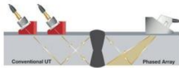
Figure 2.16. Contrôle par PA [11]
