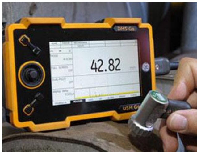
Figure43.4. Contrôle de l'arbre par ultrason
