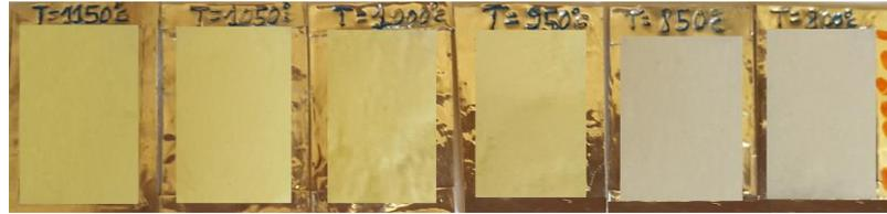
Figure 4-16 : Échantillons préparés pour l'étude de l'effet thermique
