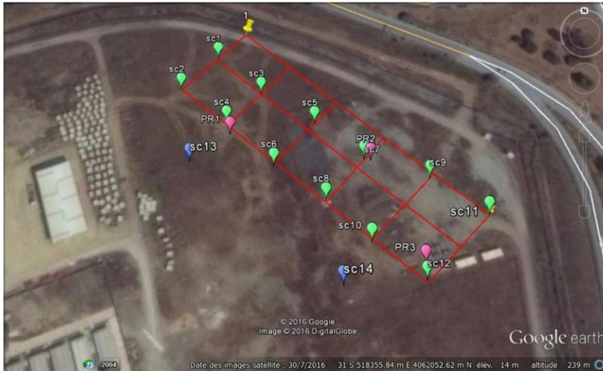
Image Google montrant l'implantation des sondages pressiométrique (PR) et sondage carotté (SC)
