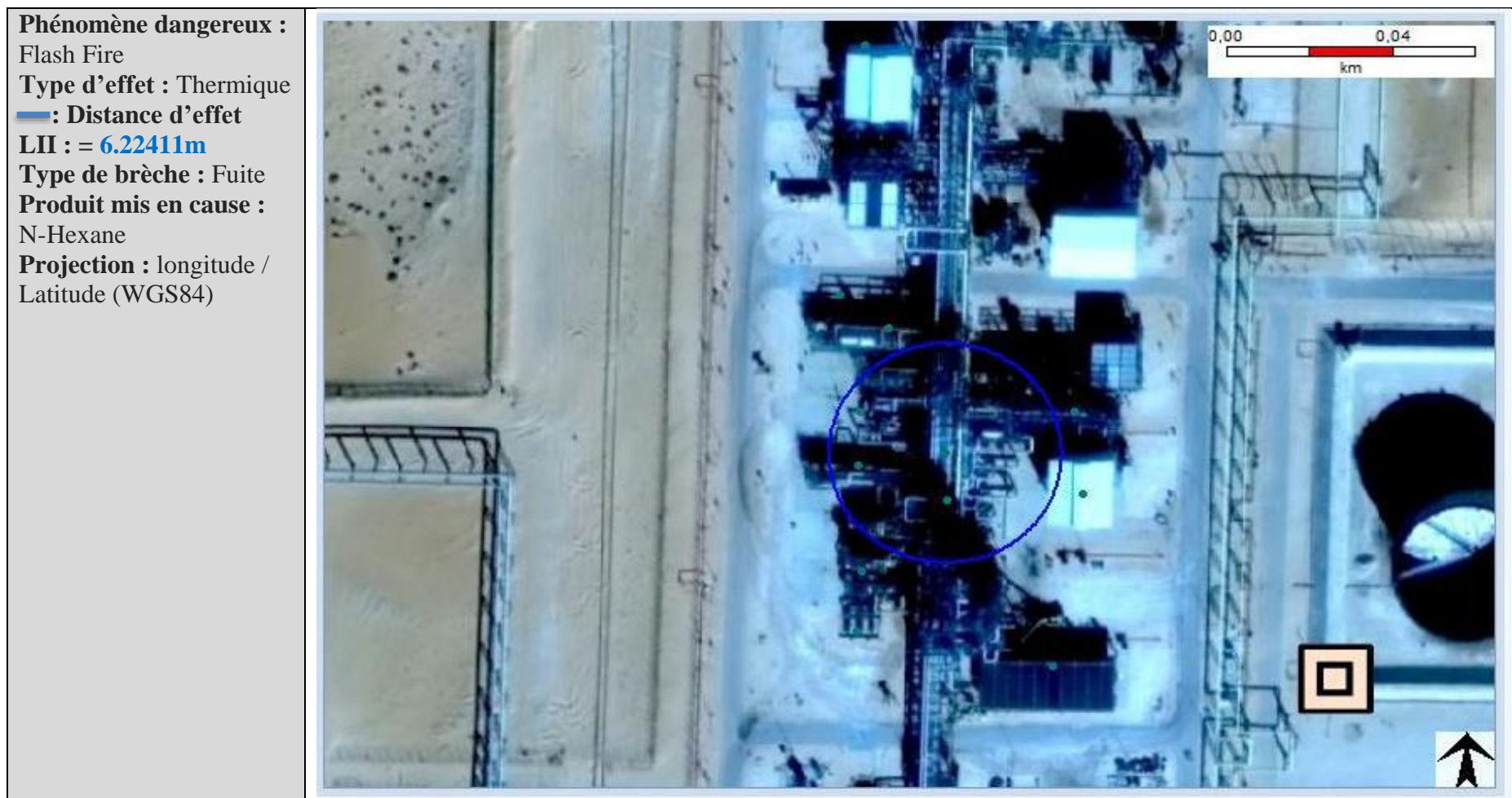
FIGURE 5. 2- Cartographie du rayon d'effet d'un Flash Fire pour une fuite au niveau de la pompe 210PA304 (phase liquide)
