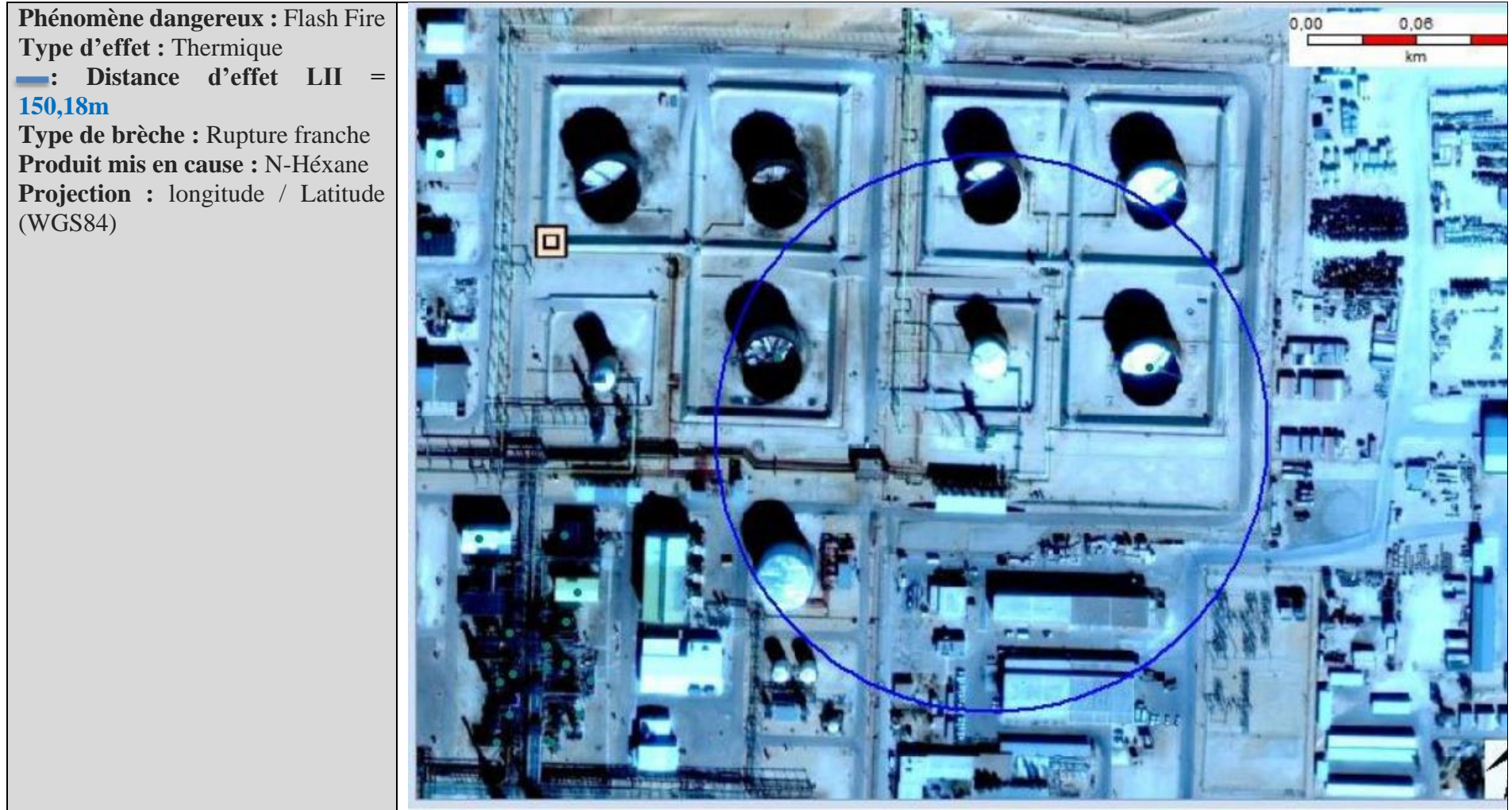
FIGURE 5. 3- Cartographie du rayon d'effet d'un Flash Fire suite à une rupture franche au niveau du Gaz Boot 250C01 (phase liquide)
