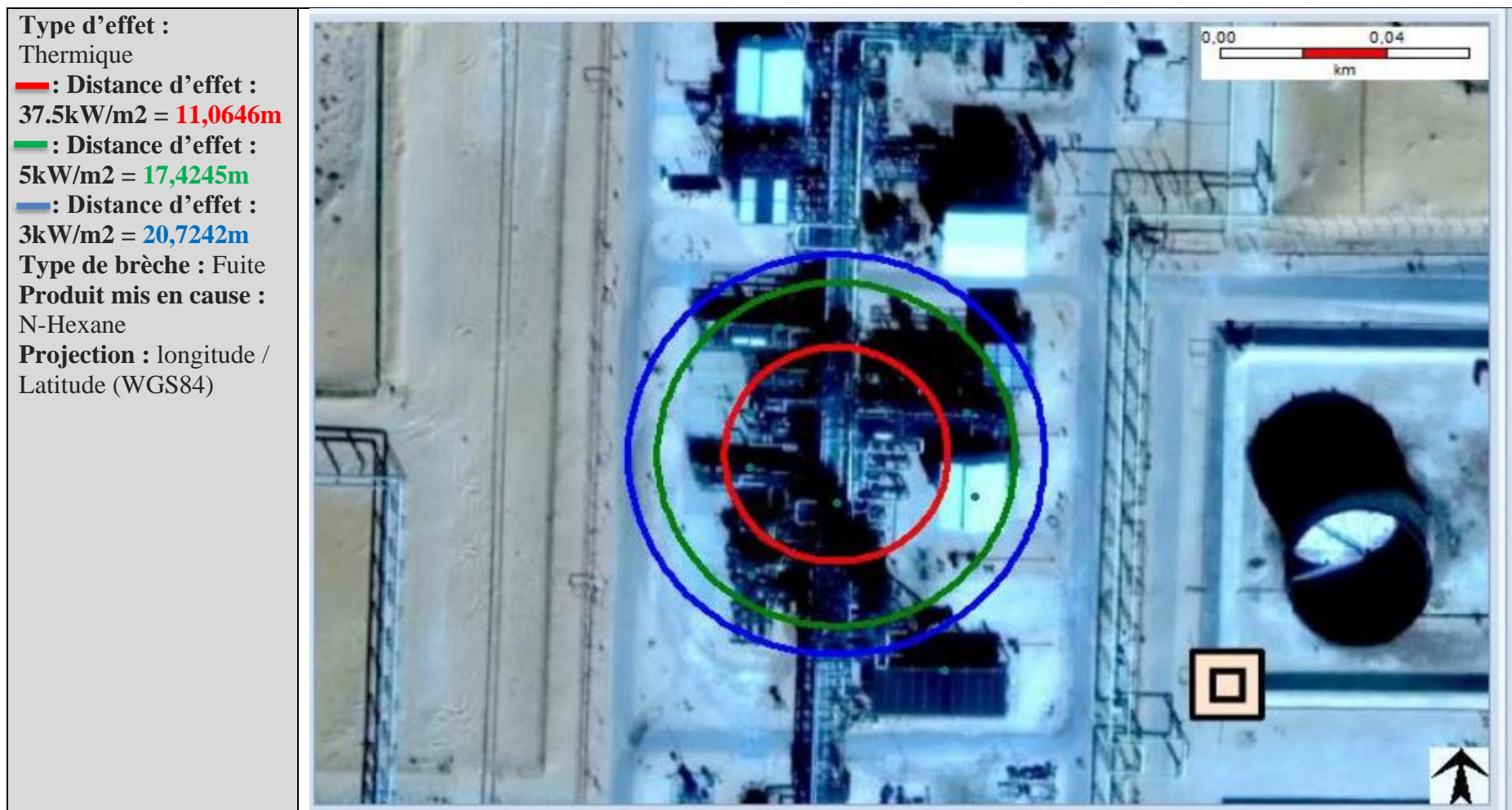
FIGURE 5. 1 - Cartographie du rayon d'effet d'un Jet Fire pour une fuite de la pompe 210PA304 (phase liquide)
