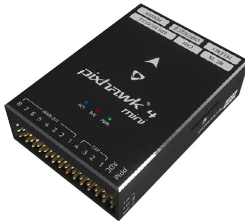
Figure 1.2: Pixhawk 4 mini autopilot board
