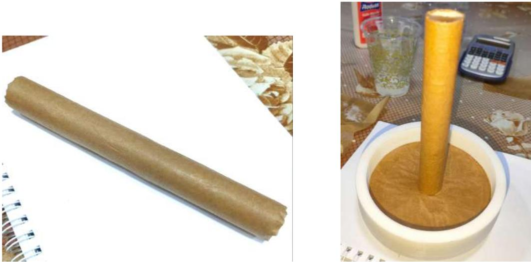
FIGURE 4.35 – Application du papier sulfurisé pour faciliter le démoulage
