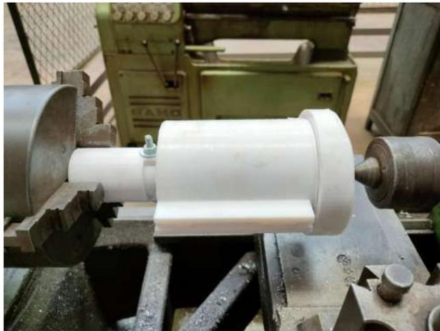
FIGURE 4.41 – Montage du moule dans le tour
