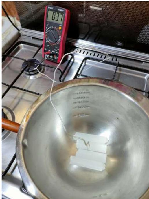
FIGURE 2.6 – Mesure de la température de fusion de la paraffine
