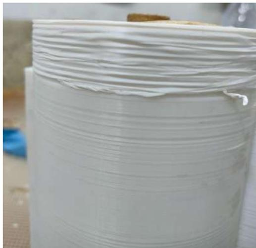
FIGURE 4.36 – Application du ruban Téflon sur le filetage du moule
