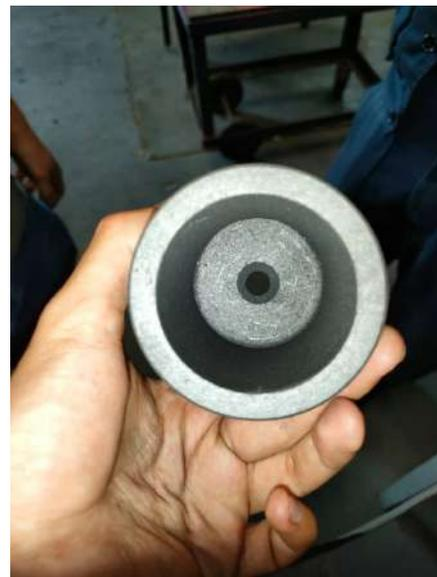
FIGURE 4.46 – Produit final de la tuyère dans son support
