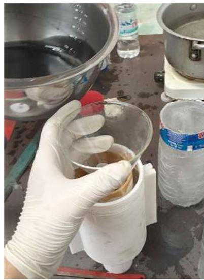
(d) Coulée du carburant en fusion dans le moule
