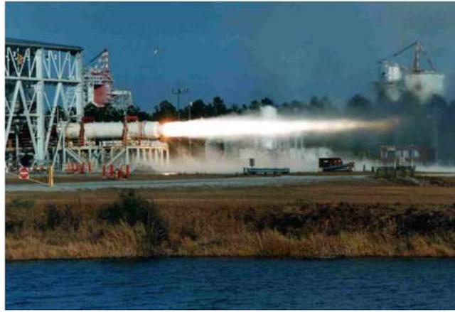
FIGURE 1.8 – Troisième test statique du propulseur du HPDP
