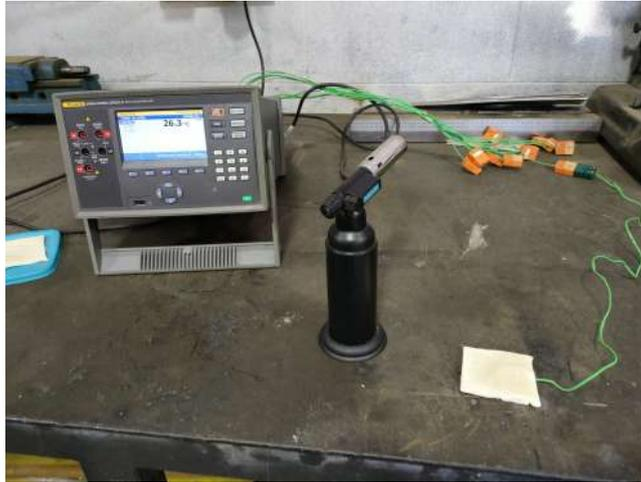
FIGURE 2.42 – Dispositif du test thermique
