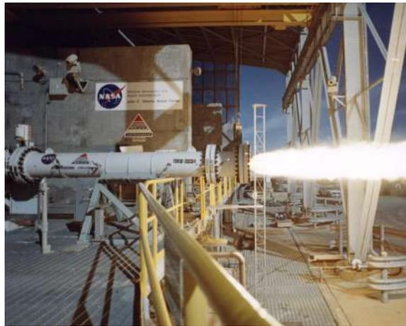
FIGURE 1.7 – Test d'un moteur-fusée à propulsion hybride de 4,5 tonnes de poussée au Stennis Space Center (NASA) en 1994
