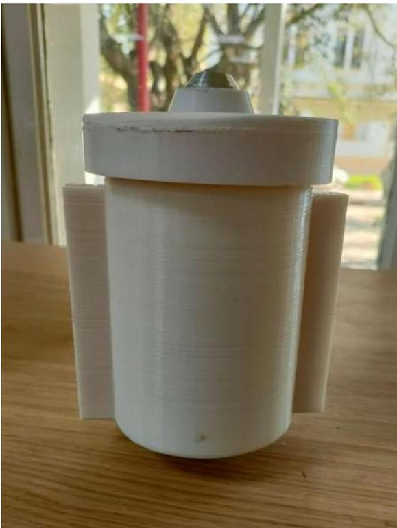
FIGURE 4.31 – Fermeture du moule
