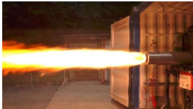
FIGURE 1.9 – Test d'un propulseur hybride d'une poussée de 10 kN chez DLR
