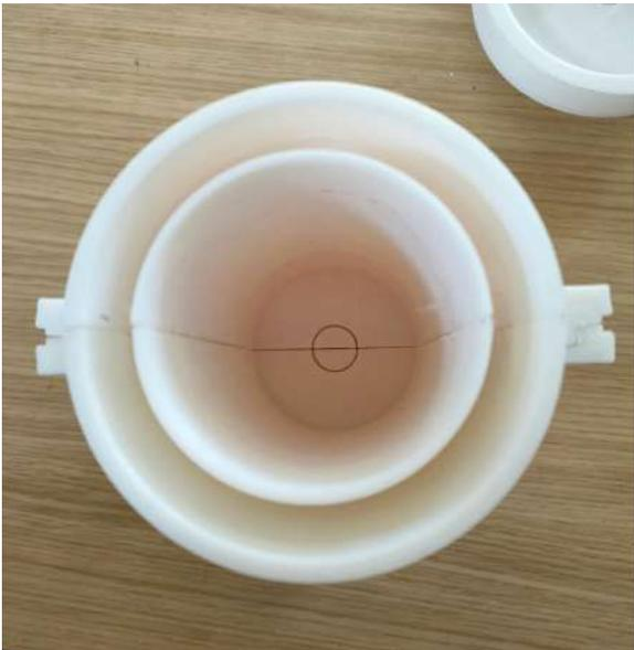
FIGURE 4.29 – Moule assemblé
