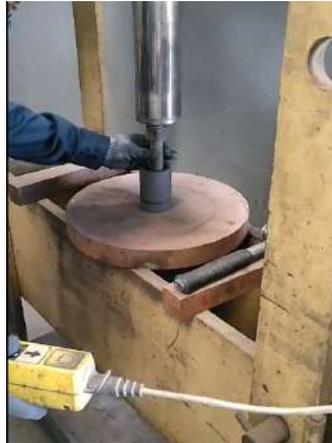
FIGURE 4.45 – Montage de la tuyère dans son support
