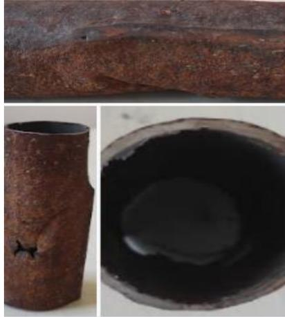
*Figure 3-8 : Echantillons N°1 présente une dégradation avancée.*
