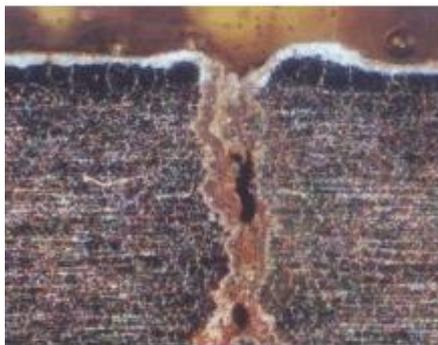
Figure 2-12 : Fissure de Corrosion fatigue, [44].
