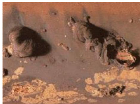
Figure 2-13 : Attaque par Oxygène, [46]
