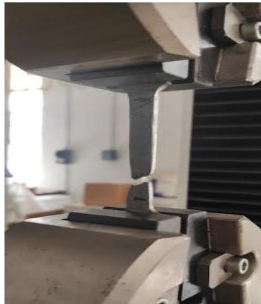
*Figure 4-6 : L'éprouvette après la rupture*
