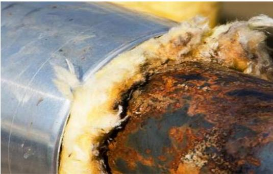
corrosion qui se produit sous l'isolant thermique utilisé pour protéger les surfaces métalliques contre la chaleur ou le froid. L'isolant thermique, également appelé calorifuge, est souvent utilisé pour protéger les tuyaux contre les variations de température, pour préserver la chaleur du fluide (isolation chaude), et pour éviter la formation de condensation (isolation chaude/froide)
