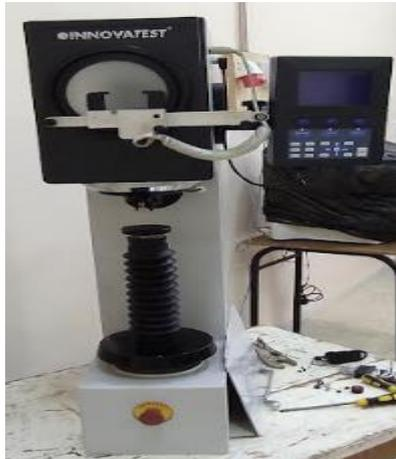
Figure 3-21 : Le duromètre utilisé
