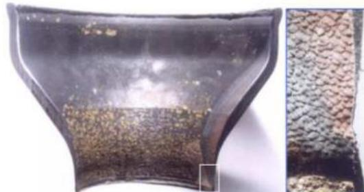
Figure 2-8 : Corrosion- Érosion dans le système d'eau, [40].
