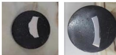
Figure 3-14 : la surface de l'échantillons à l'état miroir
