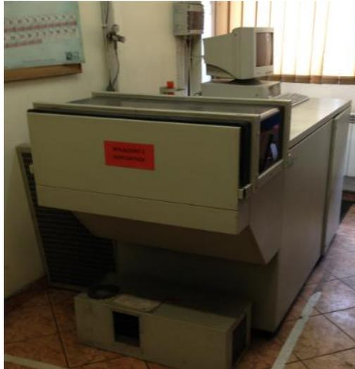
*Figure 3-16 : Spectromètre de fluorescence des rayons X*
