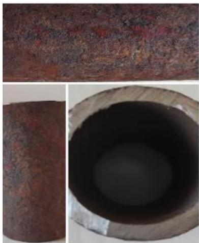
La texture de la surface est généralement altérée, avec peu de déformations ou d'irrégularités notables. Des traces de corrosion sont présentes comme la rouille, mais limitées, indiquant une perte de matière négligeable par rapport aux autres échantillons. En général, cet échantillon semble être le moins affecté par la corrosion sous calorifuge, bien que des investigations plus approfondies puissent être nécessaires pour évaluer pleinement son état.
