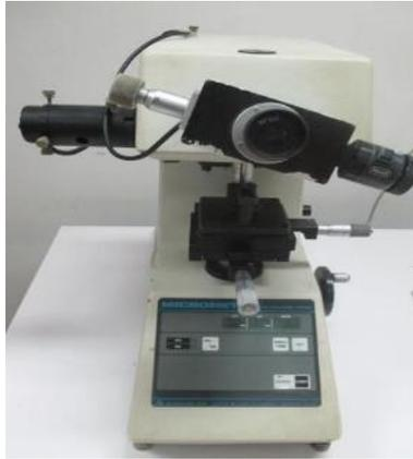
Figure 3-19 : Microduromètre utilisé.
