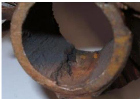
Figure 2-14 : Corrosion caustique, [46]
