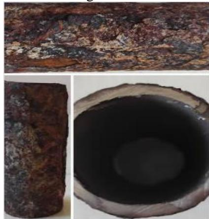
*Figure 3-9 : Echantillon N°2 présente une dégradation partielle*
