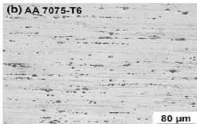
Figure 1.6: Microstructure de l'alliage 7075-T6 laminé
