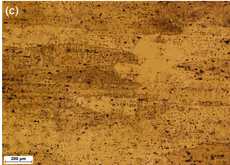
Figure 5.8: Les microstructures MO de la section RD-TD de Al7075 après 16h de traitement à 150°C des échantillons avec (a) 12,65 %, (b) 32,39 % et (c) 55,47% de réduction d'épaisseur
