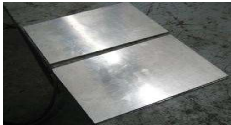
Figure 3.1 : Tôles d'Aluminium 7075 de dimensions 200 x 200 x 4 mm
