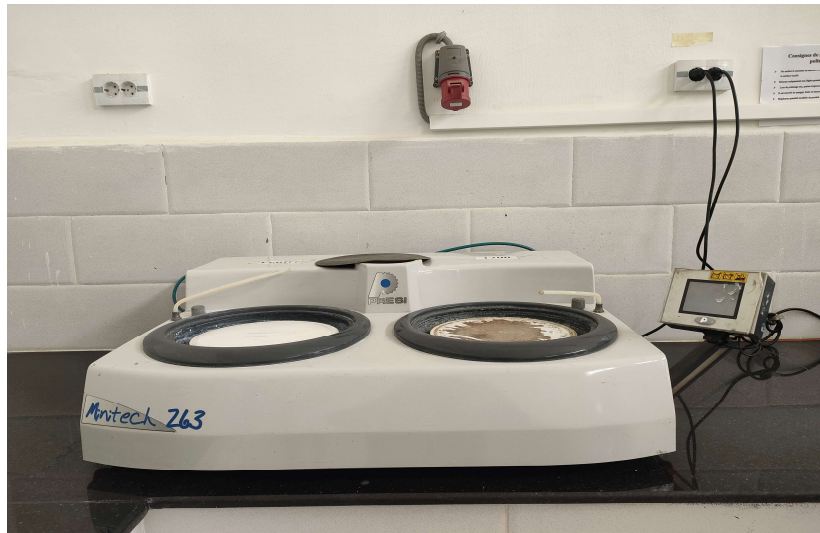
Figure 3.11 : polisseuse métallographique (Minitech-263)
