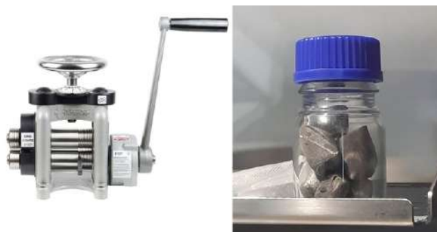
FIGURE 3.1 – (a) Laminoir de bijouterie utilisé pour presser les feuilles de lithium, (b) Lingots de Lithium
