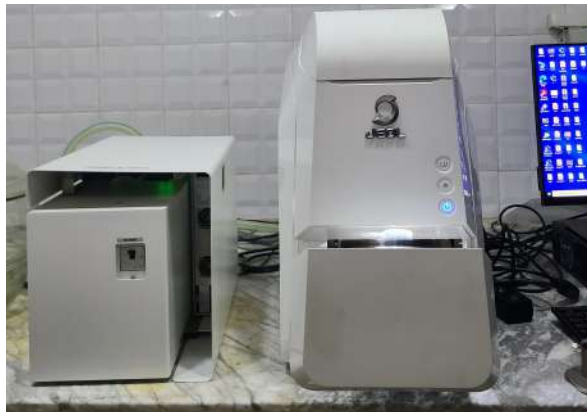
FIGURE 3.11 – Le Microscope électronique à balayage utilisé pour la caractérisation
