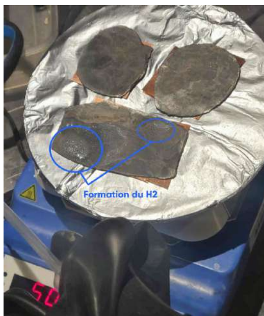
FIGURE 3.3 – Formation de LiH_2PO_4 sur la surface du lithium, accompagnée de l'apparition de bulles d'hydrogène résultant de la réaction
