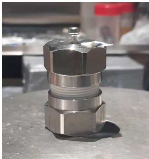
FIGURE 3.6 – Photo réel de cellule Swagelok
