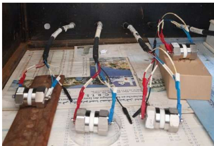
FIGURE 3.14 – Photo réel des cellule en cours de mesure électrochimique reliées au potentiostat-galvanostat
