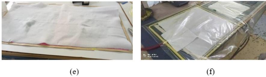
FIGURE 2.8 – Étapes d'élaboration (e) Application du tissu de drainage (f) Mise en place d'une couche de film
