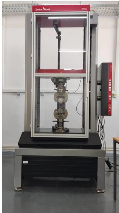
FIGURE 2.12 – Dispositif d'essais de traction Zwick Rowell
